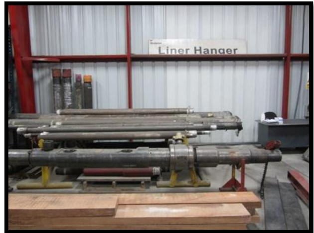
Al igual que Fishing, la línea Liner Hanger presenta solo la actividad de almacenamiento de las brocas de perforación en la Base Iquitos. Estas herramientas de perforación se encuentran apiladas y sujetadas en racks. Existen brocas apiladas en el suelo sin señalización, pero en poca cantidad lo cual hacer permisible el tránsito peatonal, representando un riesgo mínimo.
