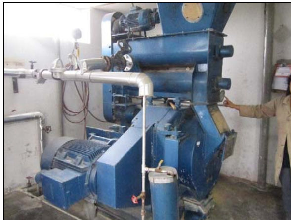
Foto 24: Prensadora, contiene moldes con ranuras, gracias a eso se forman los pellets
