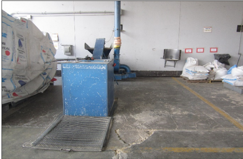
Foto 16: Máquina moladora de insumos como maíz, soya, harina integral, heno de alfalfa
