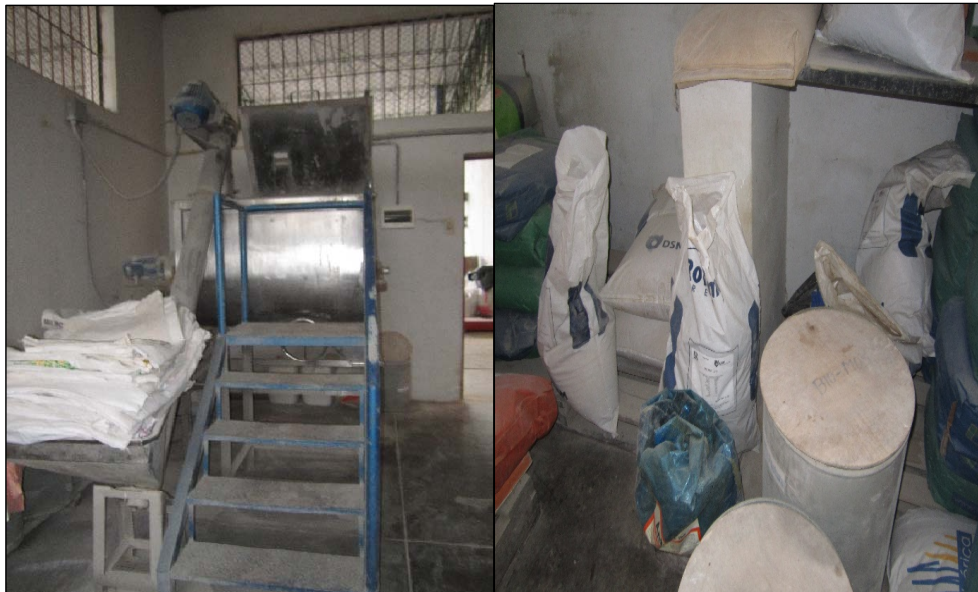
Foto 17: Mezcladora grande para combinar y mezclar insumos
