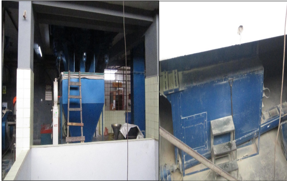
Foto 22: Tolva dosificadoras en donde se depositan los diferentes ingredientes a utilizar Foto 23: Mezcladora, en esta parte se combina todos los ingredientes provenientes de la tolva dosificadora
