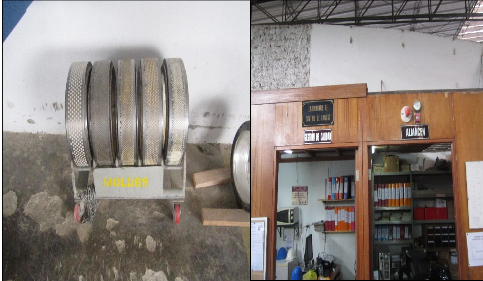
Foto 25: Tamices donde quedan adheridos los alimentos, previo dosificado de vapor
