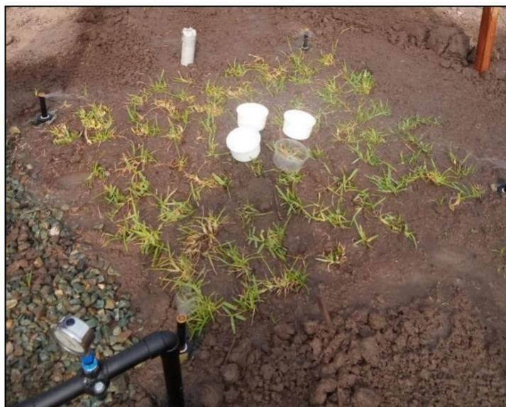
**Figura 53: Determinación de la lámina de riego en un lisímetro**
