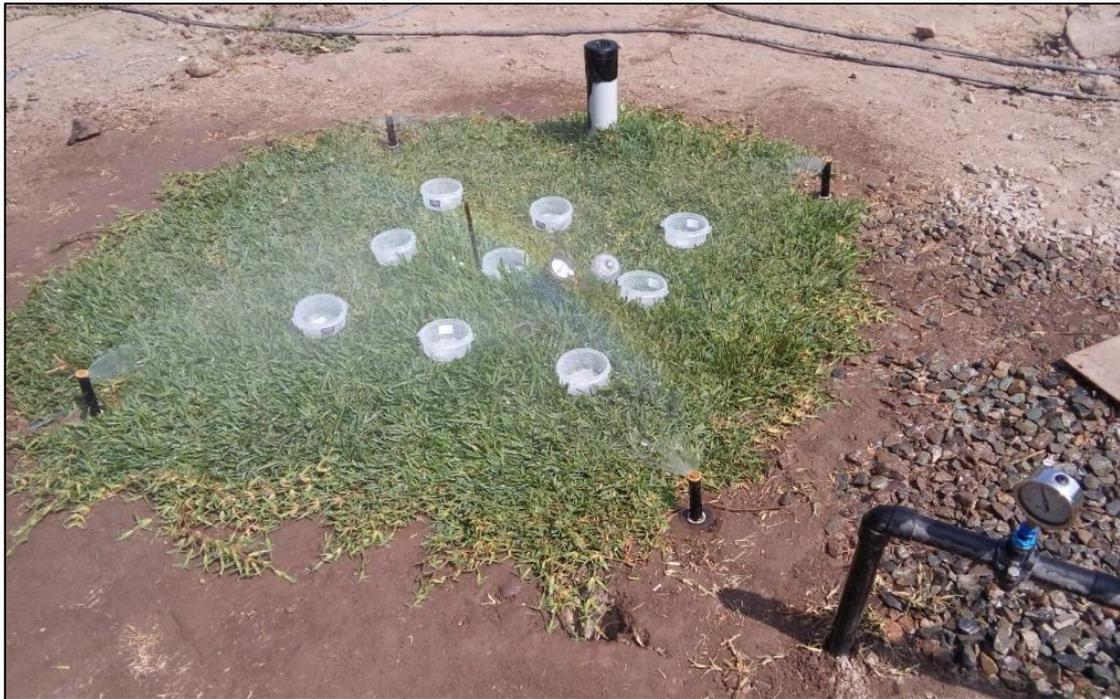
**Figura 51: Prueba de uniformidad en una parcela experimental**
