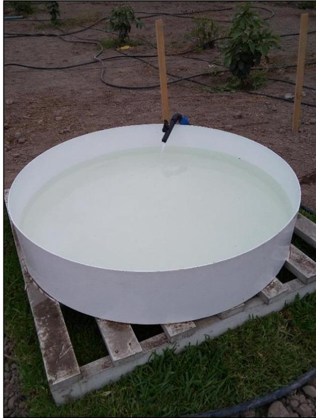
**Figura 75: Llenado del tanque evaporímetro**
