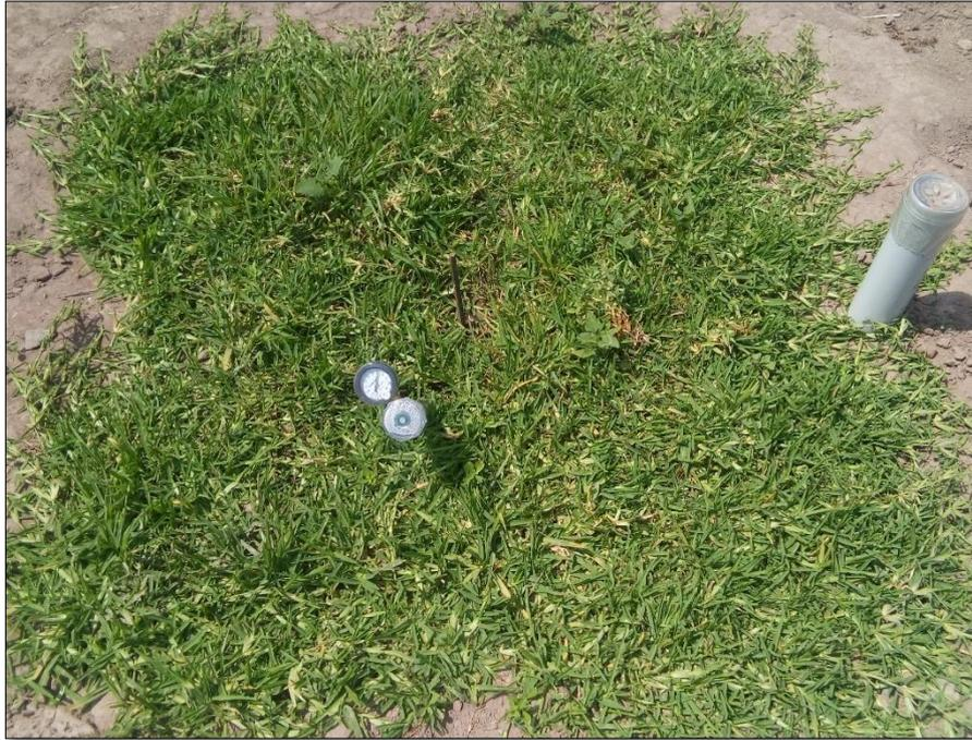
**Figura 37: Tensiómetros instalados en campo**
