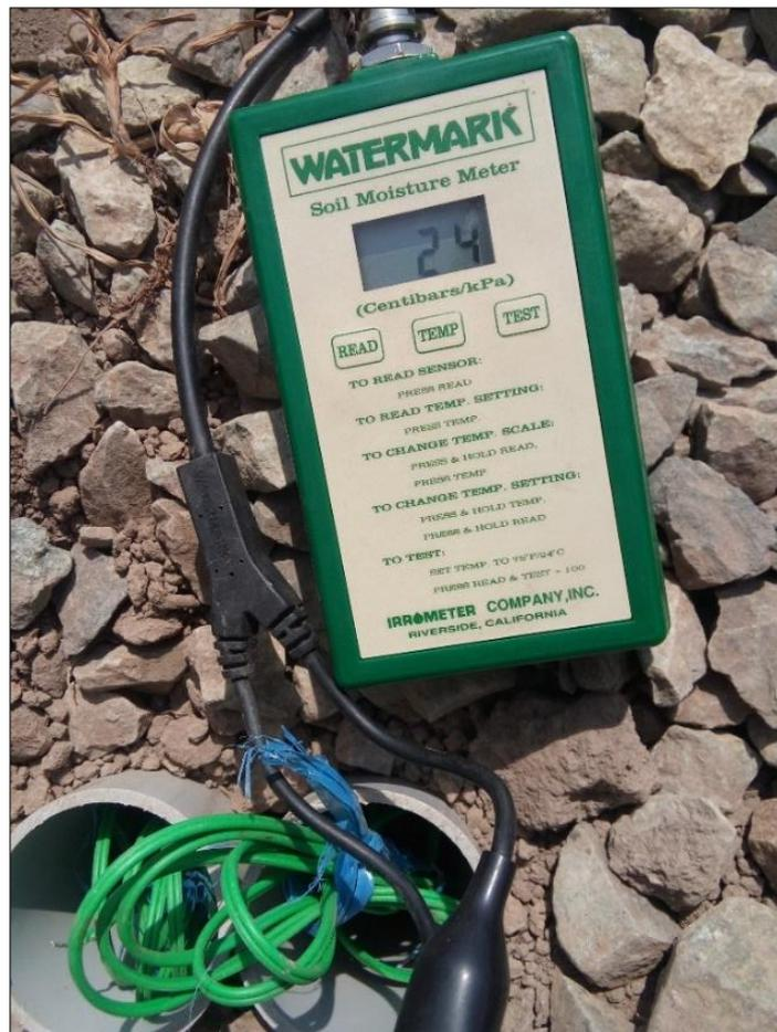
**Figura 39: Medidor digital de humedad Watermark**
