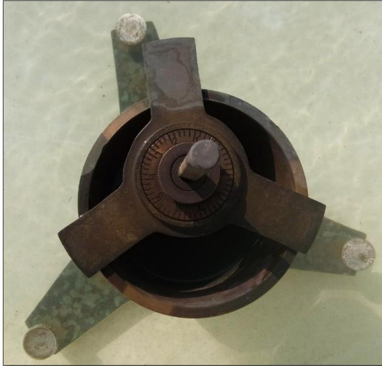
**Figura 31: Tornillo micrométrico y pozo de estabilización**
