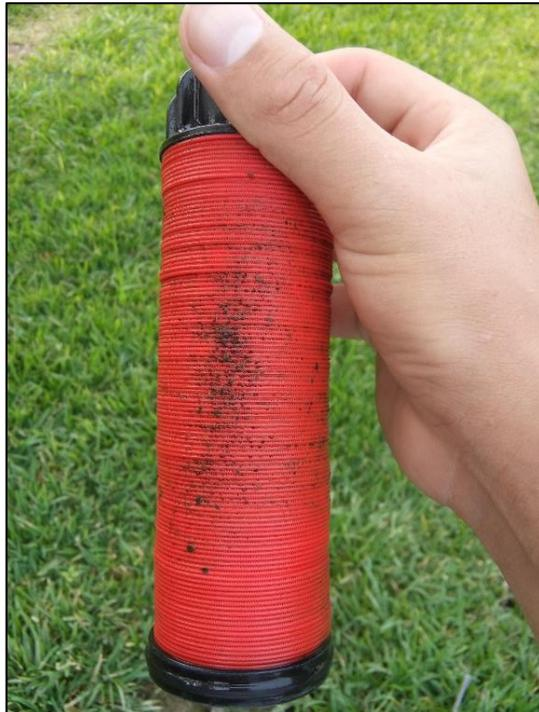
**Figura 82: Mantenimientos de los filtros en el cabezal de riego**
