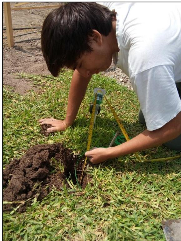
**Figura 80: Medición de la profundidad de los sensores Watermark**
