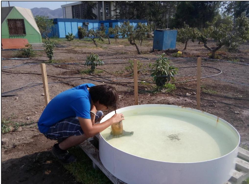
**Figura 74: Reconocimiento del tanque evaporímetro y ajuste el tornillo micrométrico**
