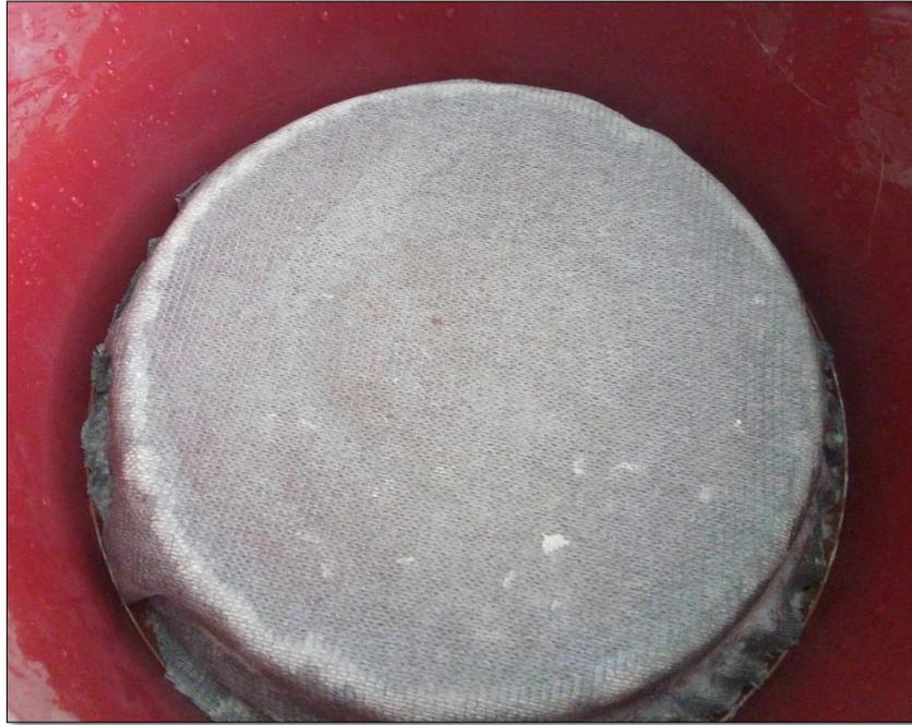
**Figura 25: División entre la capa de grava y tierra al interior del lisímetro**
