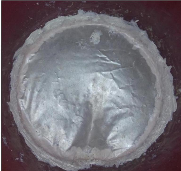
**Figura 23: Base del lisímetro con su respectiva pendiente**
