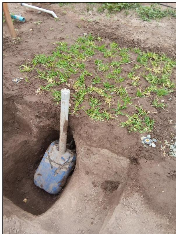
**Figura 78: Vista del almacén del agua drenada del lisímetro en campo**
