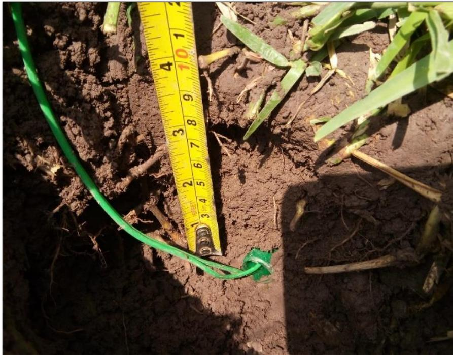
**Figura 38: Instalación de sensores Watermark a 10 cm. de profundidad**
