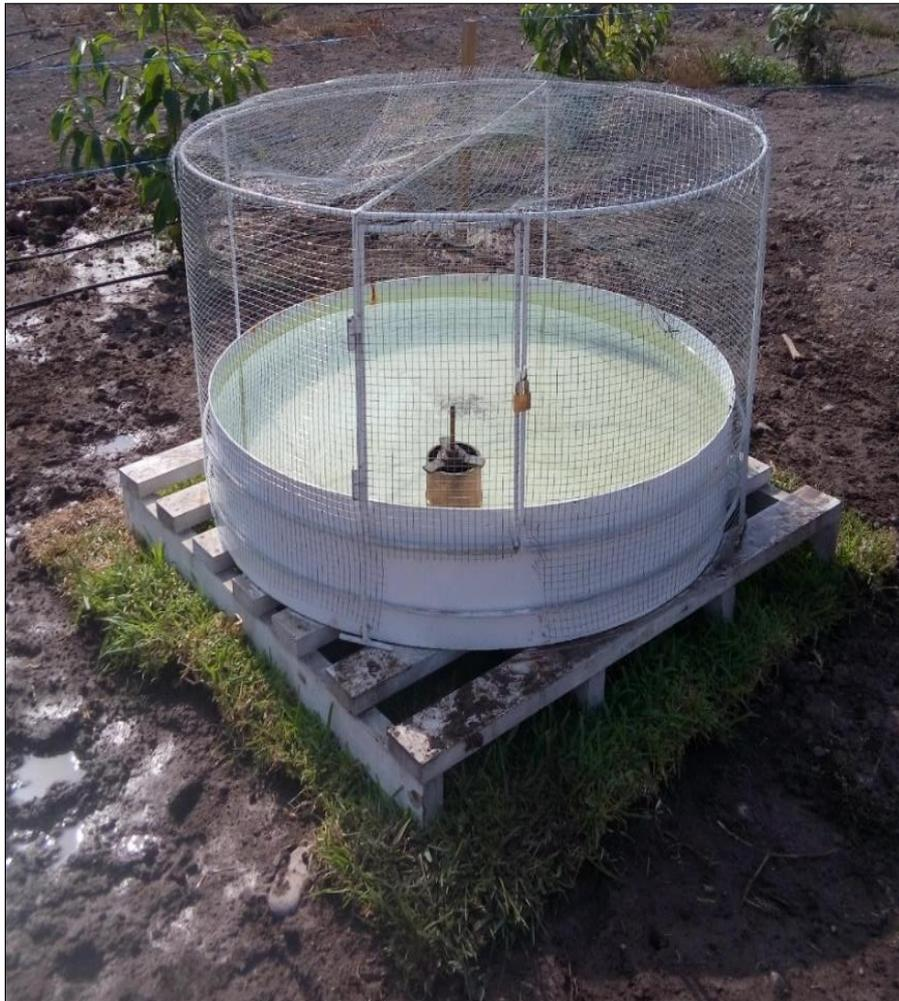
**Figura 30: Tanque evaporímetro clase A**
