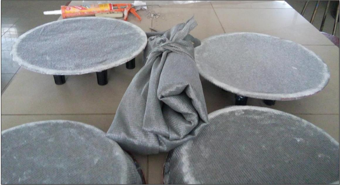
**Figura 21: Platos de plástico cubiertos con mala raschel 90 por ciento**
