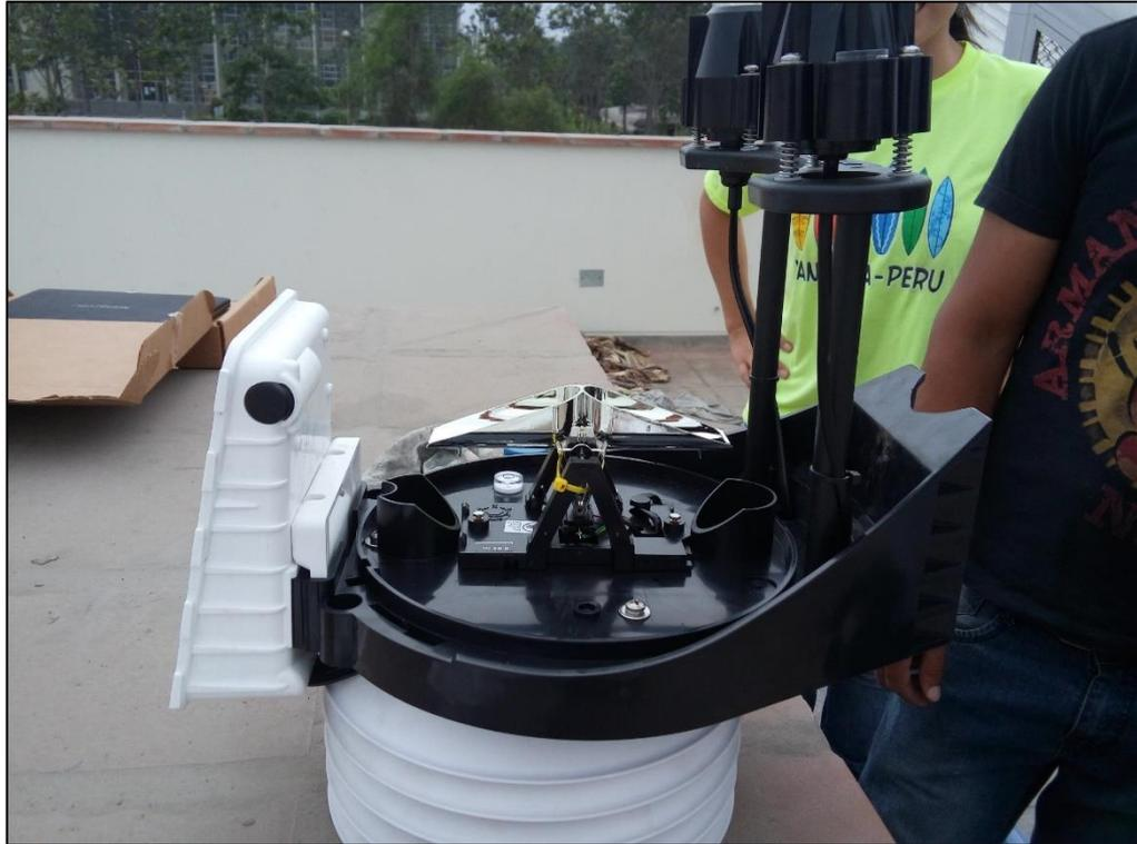
**Figura 73: Pluviómetro de la estación meteorológica Davis**
