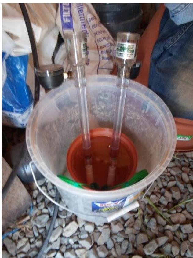
**Figura 36: Preparación de los tensiómetros y sensores Watermark para su instalación**
