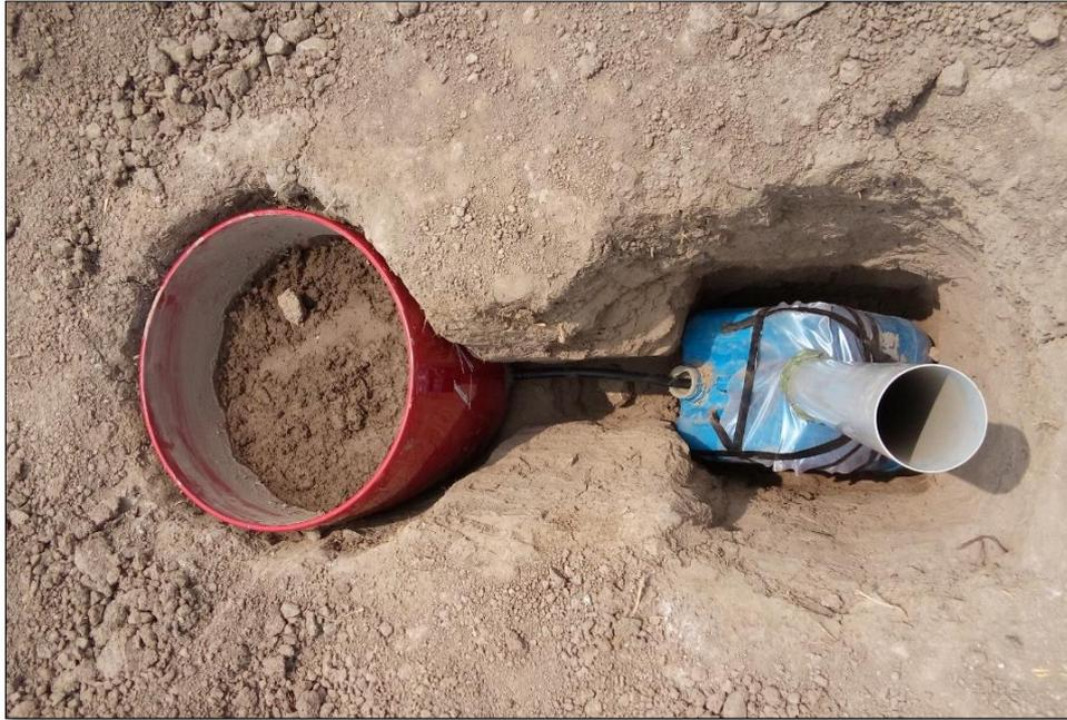
**Figura 28: Instalación del lisímetro en campo**
