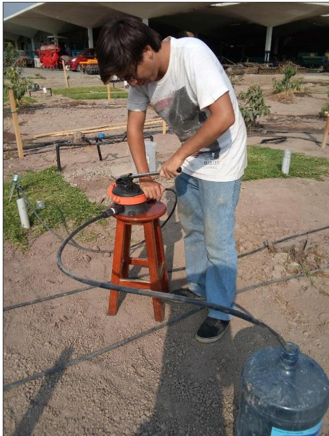
**Figura 40: Extracción de agua drenada utilizando una bomba de succión manual**
