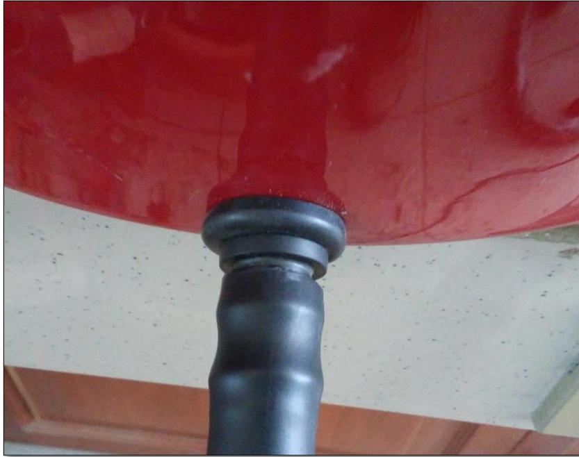
**Figura 24: Vista externa de la unión inicial en la base del lisímetro**
