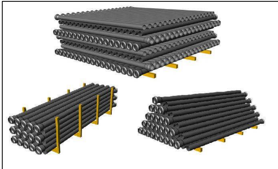
Figura 17: Modelo recomendado de almacenaje de tuberías.
