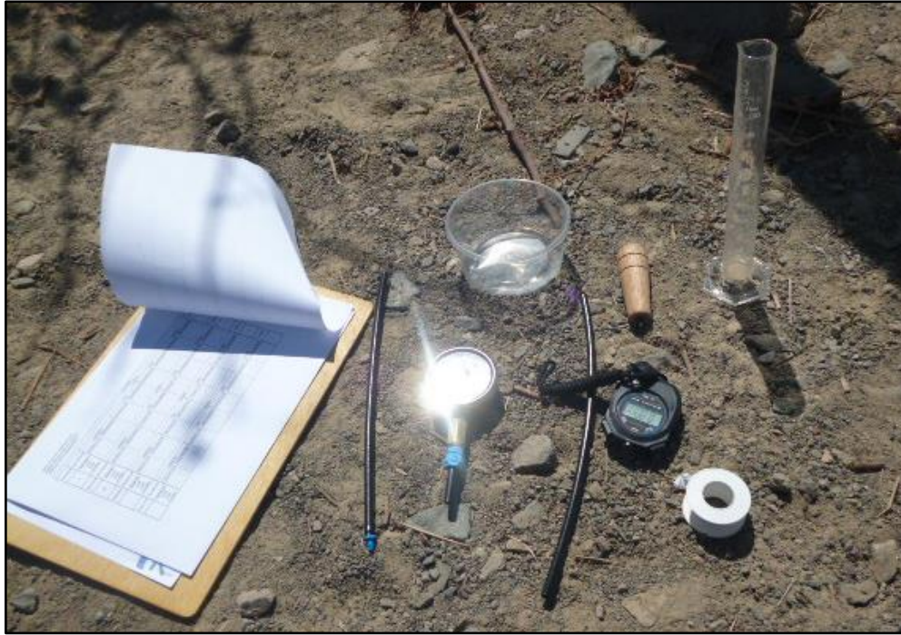
Figura 22: Materiales empleados en pruebas de coeficiente de uniformidad en campo.
