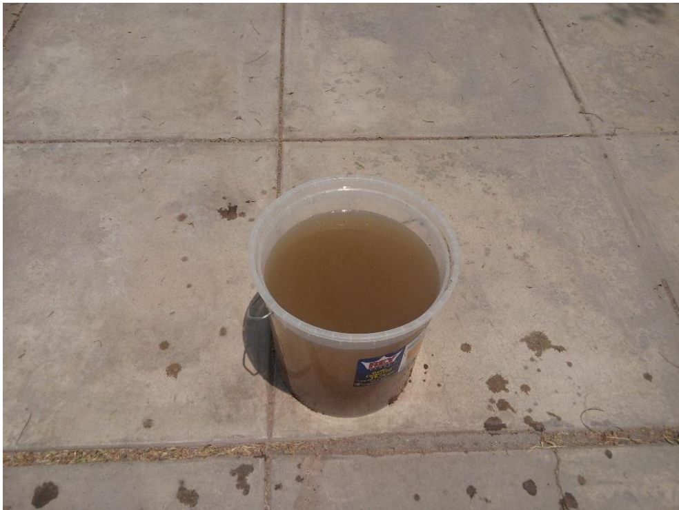
Figura 118: Agua del purgado de las mangueras subterráneas
