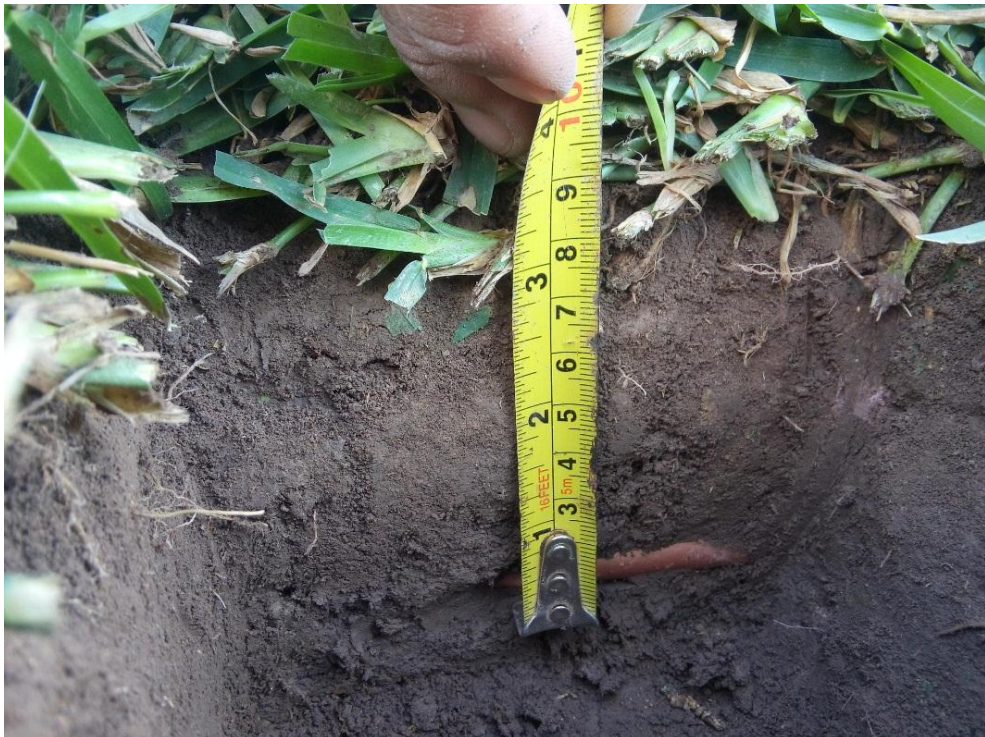
Figura 108: Profundidad de instalación de las mangueras subterráneas
