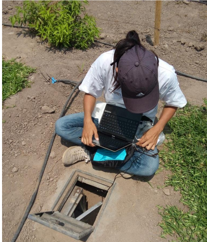
Figura 113: Descarga de datos de contenido de humedad
