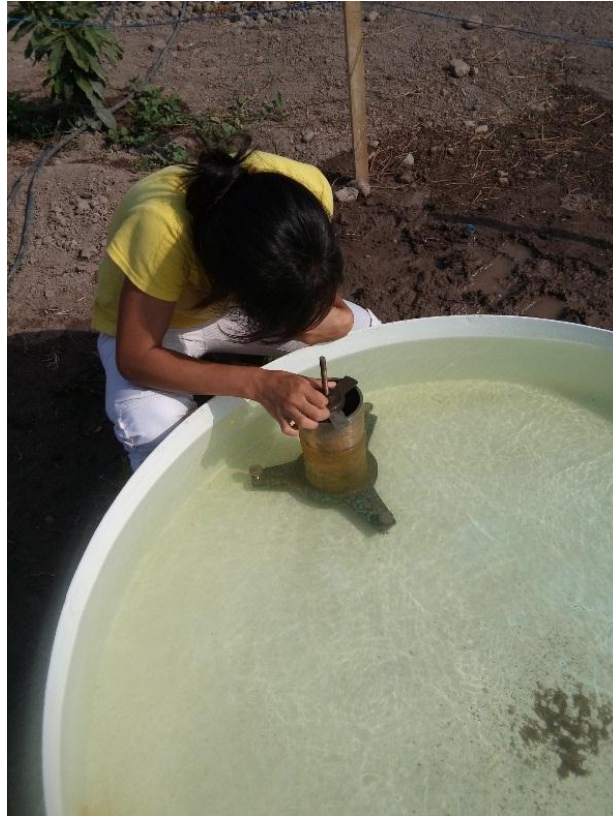
Figura 93: Calibración del tornillo micrométrico
