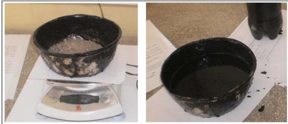
Figura 49: Mezcla de arena media y asfalto líquido
