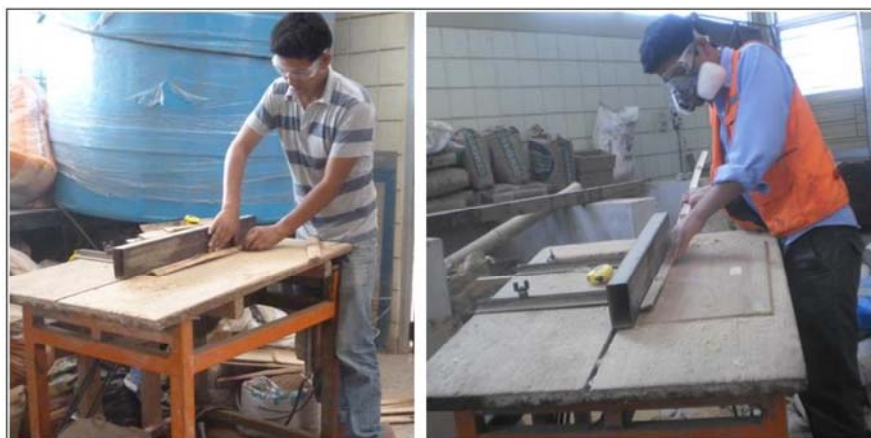
Figura 45: Fabricación de tablillas de bambú entero lisas y acanaladas
