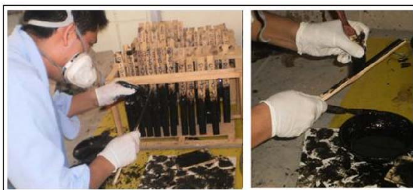
Figura 46: Impermeabilización de tablillas de bambú entero
