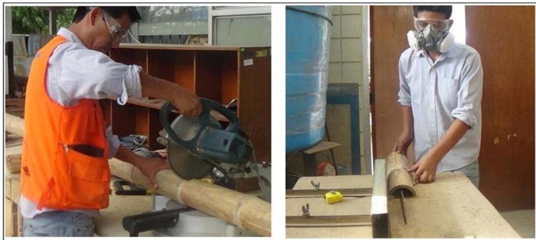
Figura 25: Corte y preparación de las probetas
