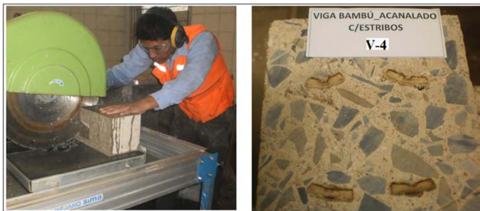
Figura 68: Corte de la viga y sección analizada
