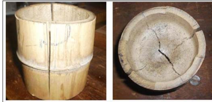
Figura 39: Falla típica del ensayo de corte paralelo
