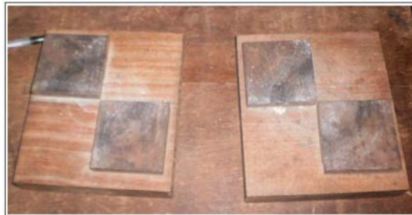
Figura 37: Dispositivos para someter a carga las cuatro secciones longitudinales
