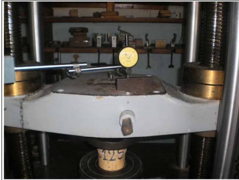
Figura 42: Dispositivo (Dial) para medir la deformación en el ensayo de compresión
