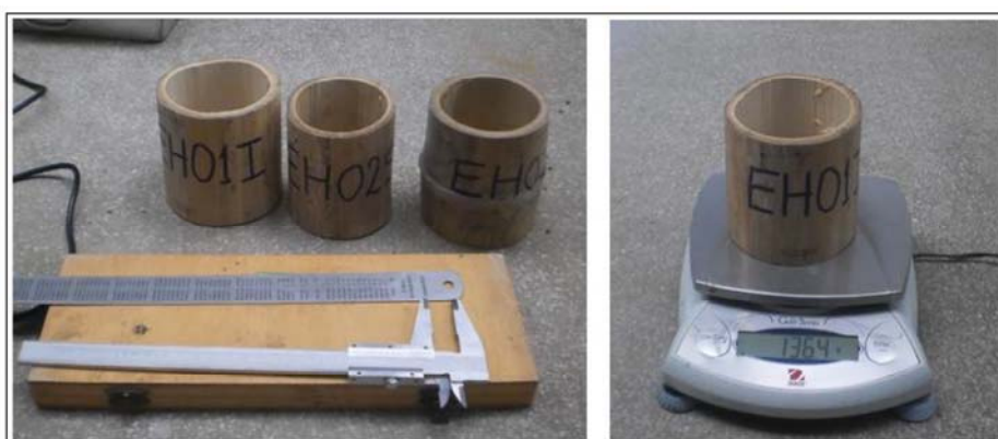
Figura 28: Medición de las dimensiones y peso
