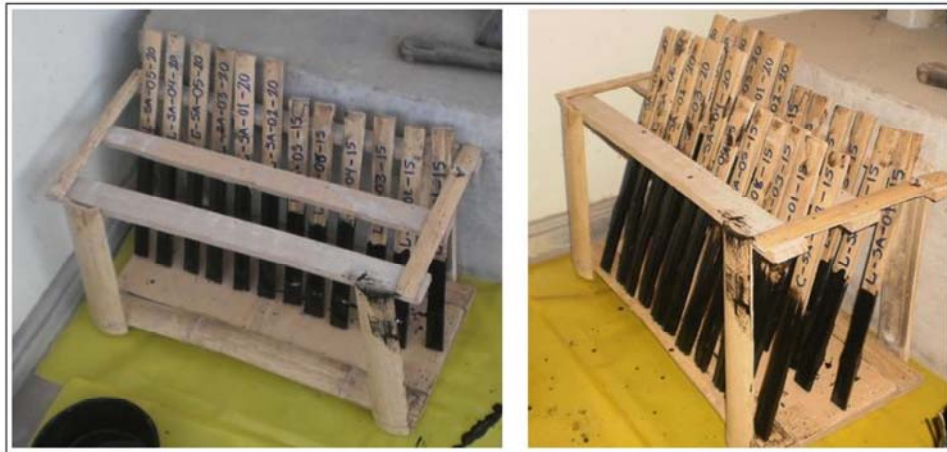
Figura 47: Secado de tablillas impermeabilizadas con asfalto RC-250
