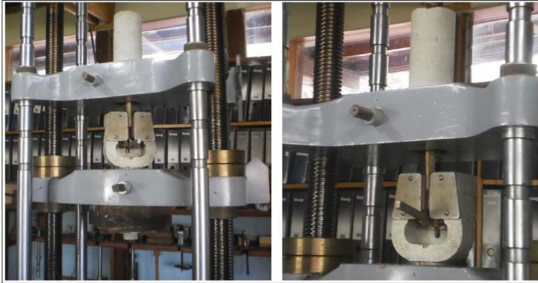
Figura 54: Ensayo de adherencia entre el bambú y concreto
