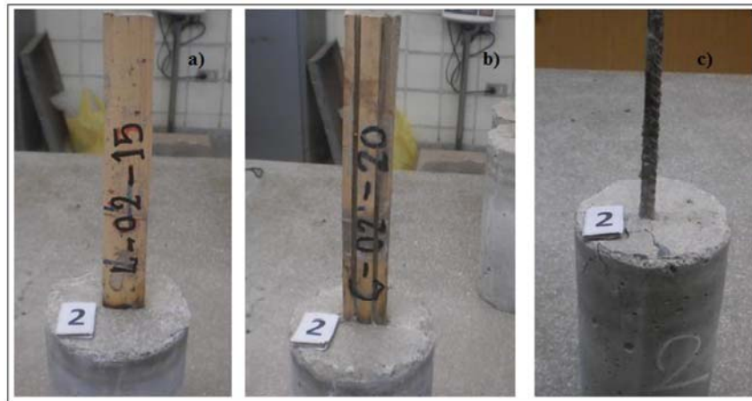
Figura 66: Tablillas sin impermeabilizar y varilla de acero
