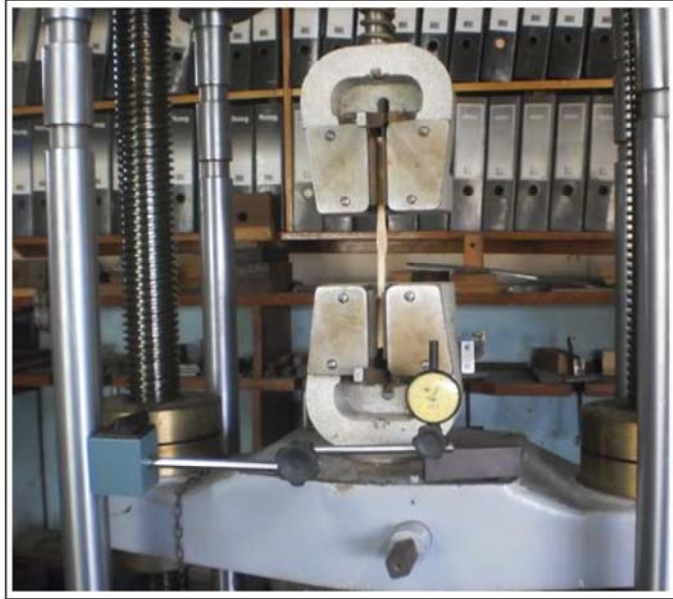
Figura 40: Dispositivo (Dial) para medir la deformación en el ensayo de tensión
