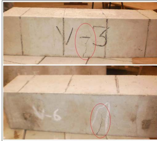
Figura 67: Estado final de fisuración de las vigas de flexión
