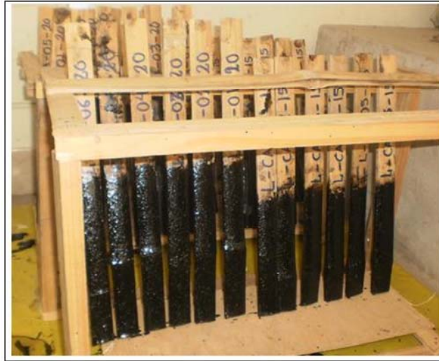
Figura 48: Tablillas impermeabilizadas con la mezcla de arena media y asfalto líquido
