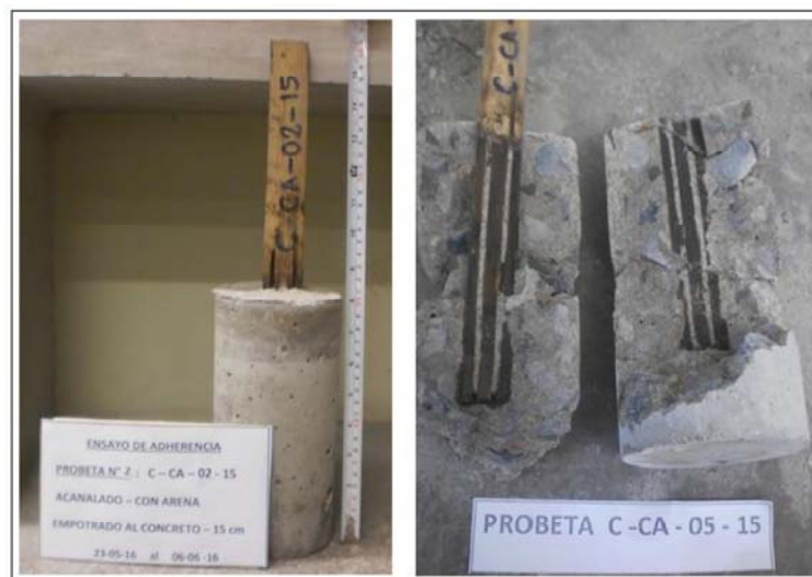
Figura 65: Especimen con tablilla acanalada e impermeabilizada
