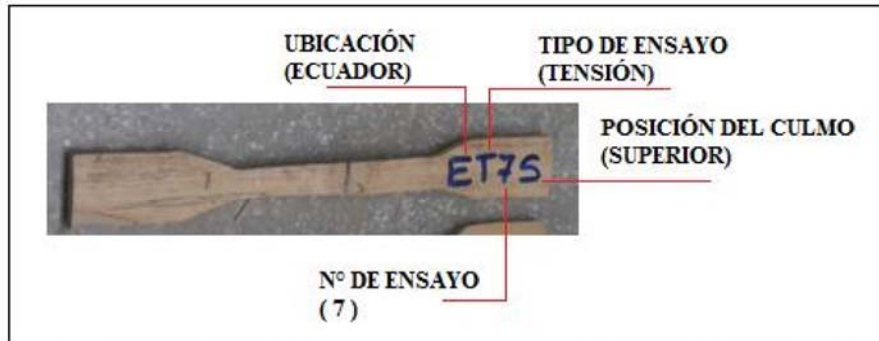
Figura 30: Identificación de probetas para los ensayos a tensión paralela
