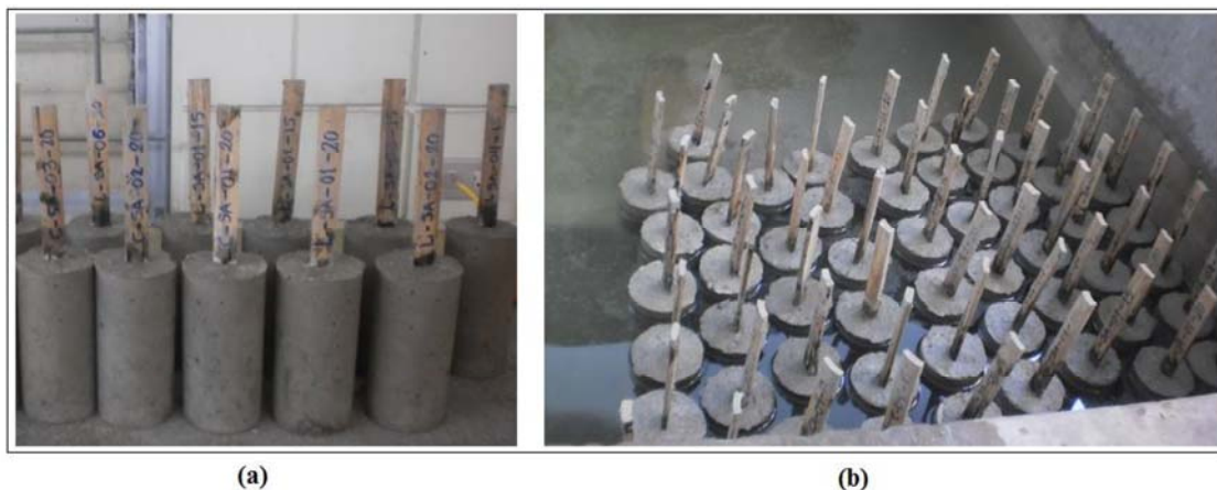
Figura 52: Desencofrado y curado de los especímenes
