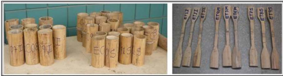
Probetas para los ensayos de compresión y corte Probetas para los ensayos de tensión Figura 26: Probetas de bambú para los ensayos
