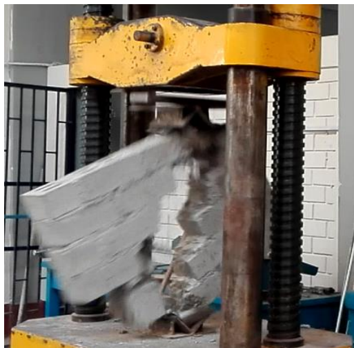
Ensayo de Compresión por murete
