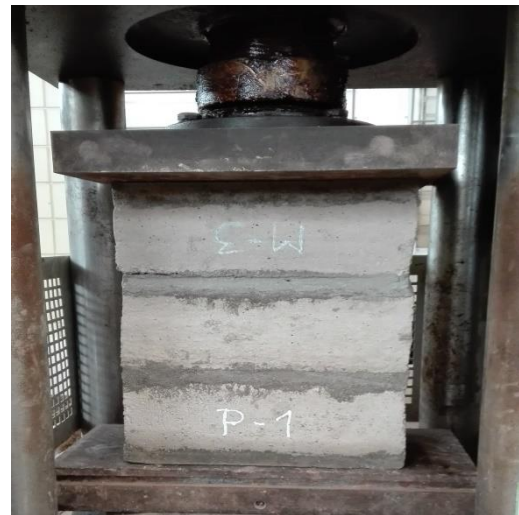
Rotura de Pilas
