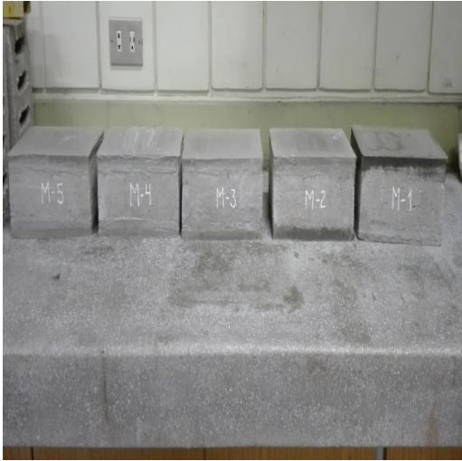
Ensayo de Compresión por unidad
