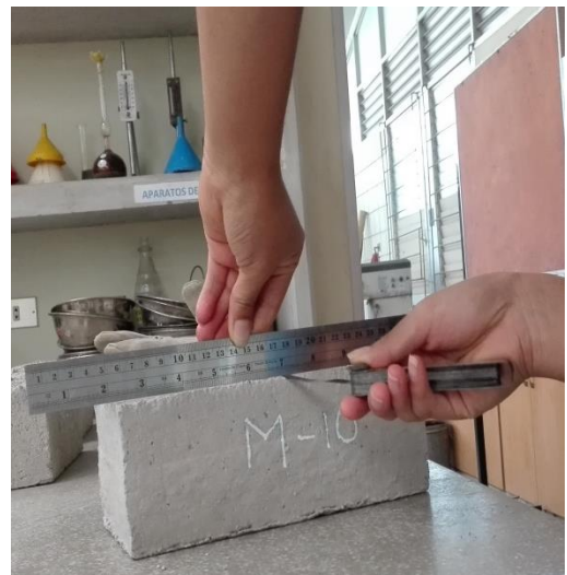
Ensayo de Alabeo
