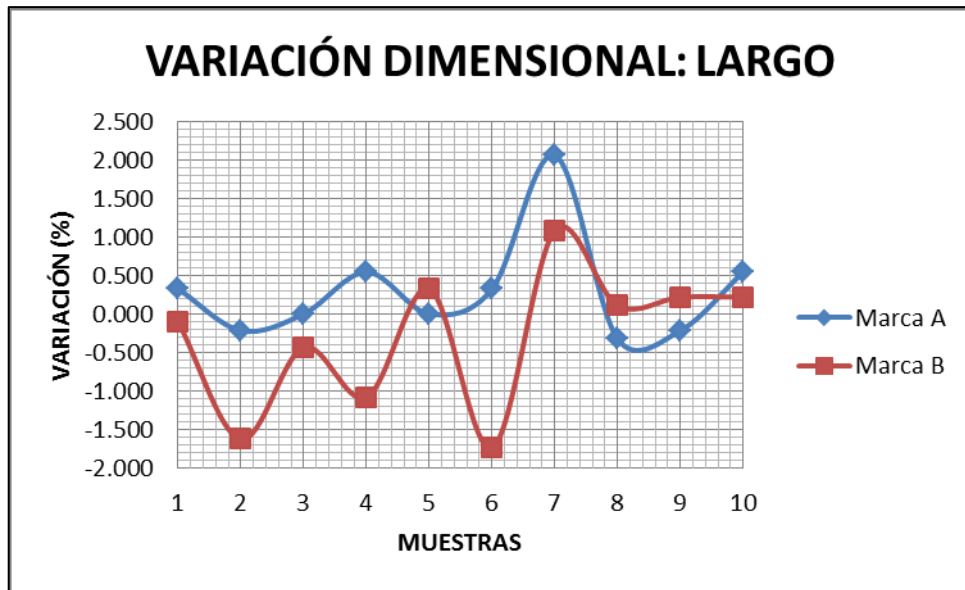
Figura 23: Variación dimensional del largo. Ladrillos industriales de arcilla
