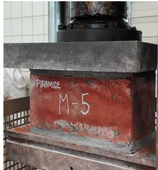
Ensayo de Compresión por Unidad
