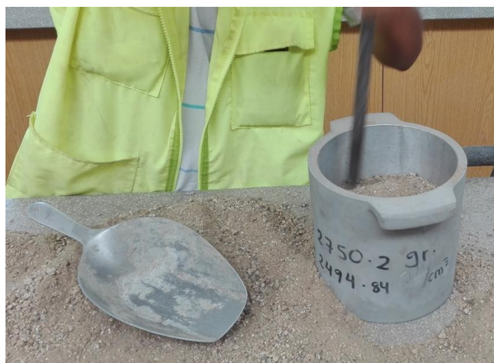
Ensayo de Peso Unitario del agregado fino
