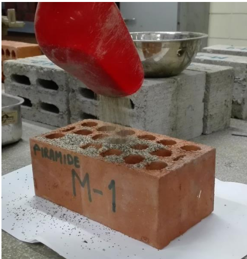
Ensayo de Porcentaje de Vacíos
