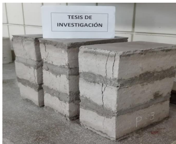
Las pilas presentaron falla en forma de grietas verticales
