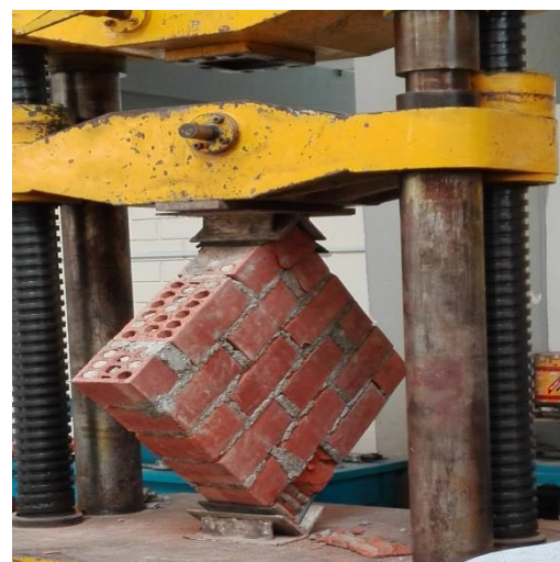
Ensayo de Compresión por Murete
