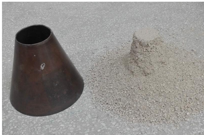
Ensayo de Absorción del agregado fino
