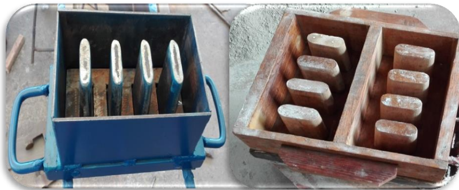
Figura 7: Molde metálico y molde dual de madera
