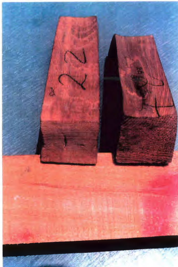
Fig. 6: Muestras de Cedro mostrando colapso
