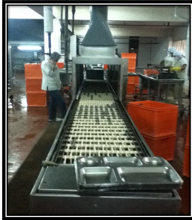
Figura 14: Máquina lavadora de platos del comedor universitario
