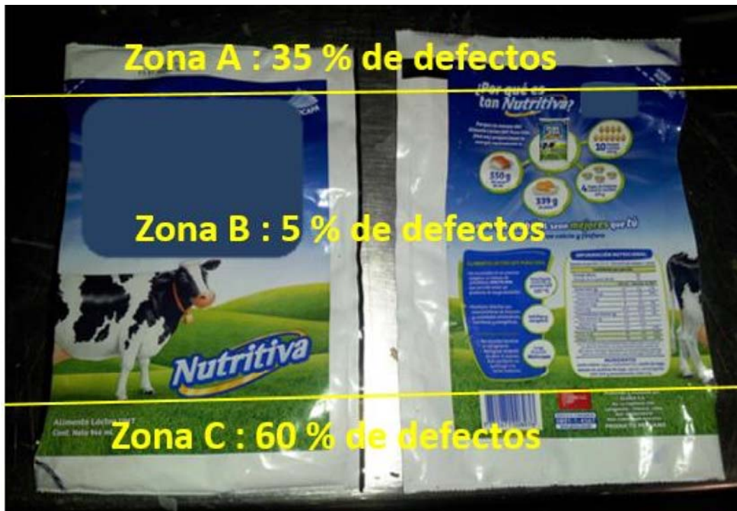
Figura 9: Defectos presentados en las bolsas.
