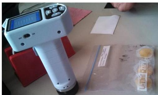
Fotografía 15: Medición de la Luminancia con el colorímetro KONICA – MINOLTA
