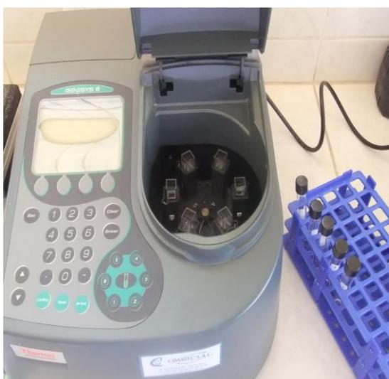
Fotografía 13: Muestras en el espectrofotómetro
