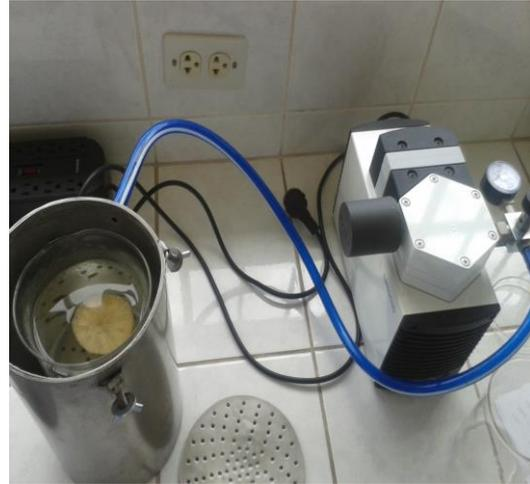
Fotografía 10: Equipo impregnador con muestra de yacón
