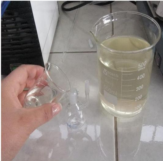
Fotografía 7: Medición de densidad de la solución a impregnar
