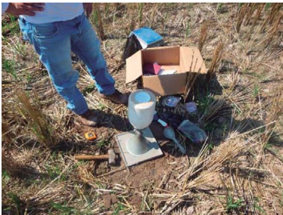
3. Uso del ensayo de Densidad en Sitio Método de la arena
