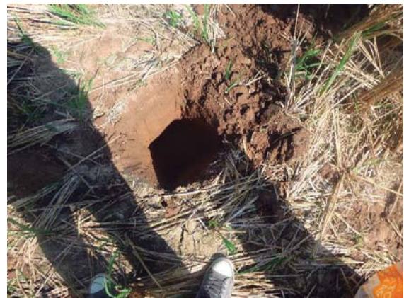
4. Obteniendo la muestra del suelo para el ensayo de Proctor modificado Método "A"
