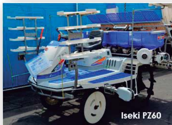
Anexo 23. Modelo de trasplantadora de seis hileras de marca Iseki PZ60 y Yanmar VP6E
