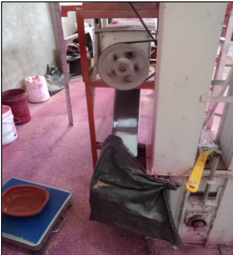
Foto 4: Máquina para tratamiento de semilla, propiedad de la empresa Agroma. Donde se realizó la aplicación de los productos a la semilla seca almacenada. Tratamiento 1.
