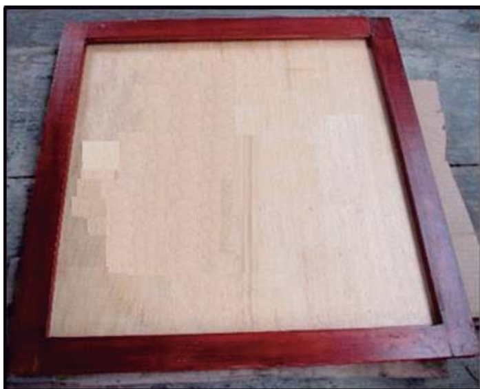
Figura 14: Moldes de madera para la elaboración de los tableros
