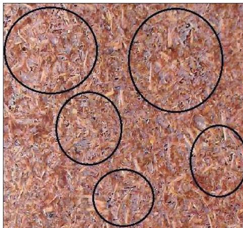
**Figura 8:** Superficie del tablero resultante plástico/bambú con espacios discontinuos.
