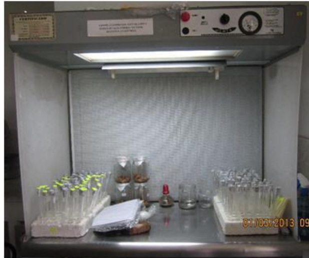
Figura 5: Cámara de flujo laminar preparada para la siembra de embriones.
