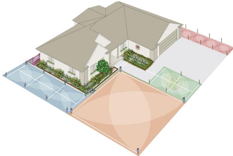
**Figura 7: Sectores de riego: Rotores, Difusores.**
