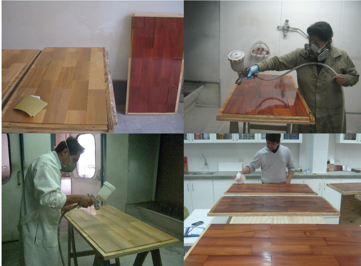
Foto 1: Preparación de paneles para la aplicación de los materiales de recubrimiento.
