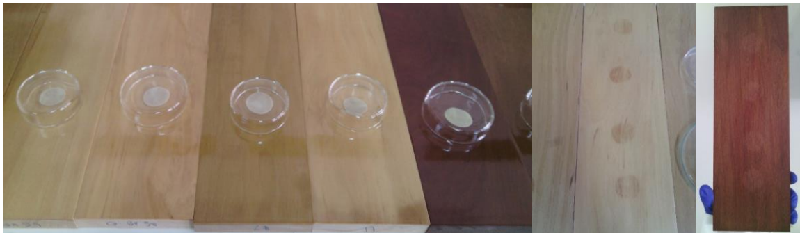
Foto 7: Determinación de la resistencia de la superficie al agua destilada.
