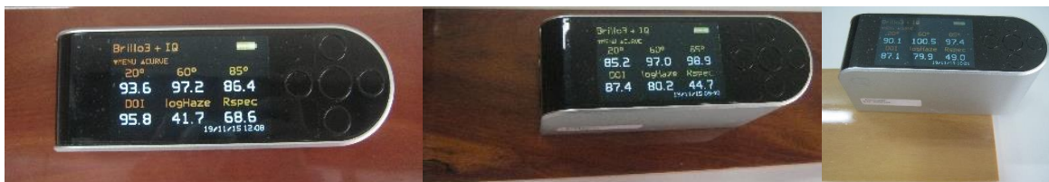
Foto 2: Medición del brillo especular
