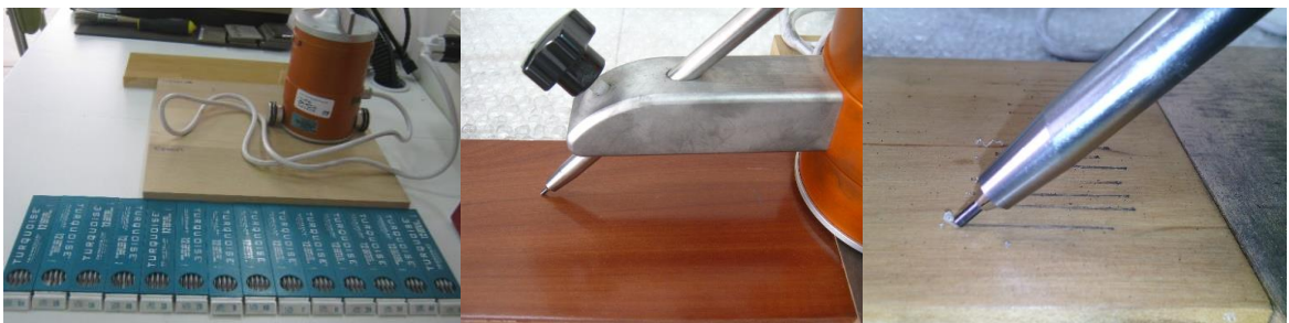
Foto 4: Determinación de la dureza de los materiales de recubrimiento
