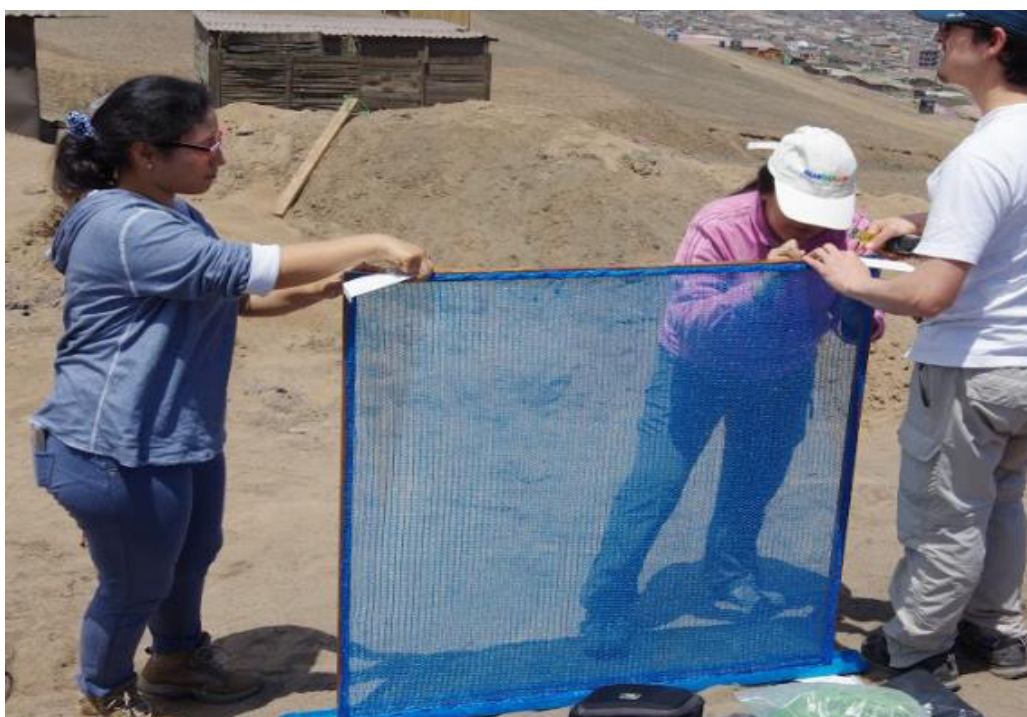
Figura 28: Marco de Neblinómetro SFC en campo
