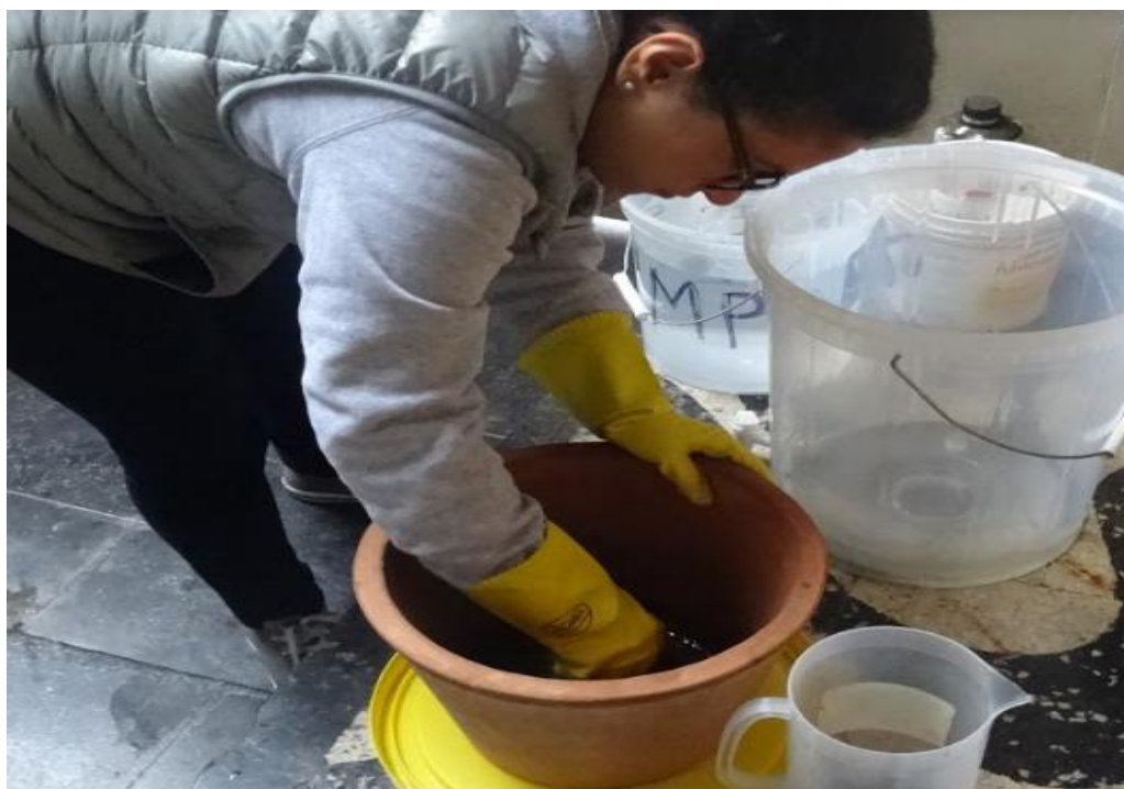
Figura 38: Limpieza y desinfección del filtro cerámico previo a su primer uso.
