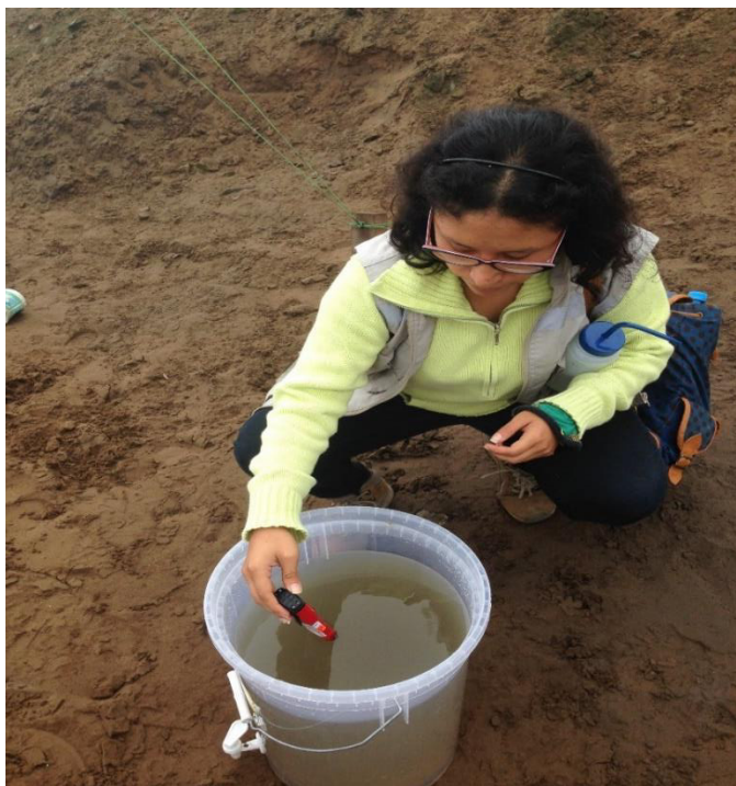
Figura 34: Medición in situ del pH del agua de neblina.
