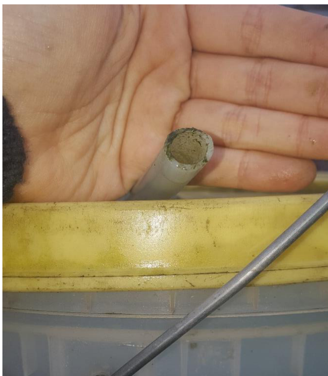
Figura 37: Presencia de moho en el sistema de distribución de agua del neblinómetro SFC.
