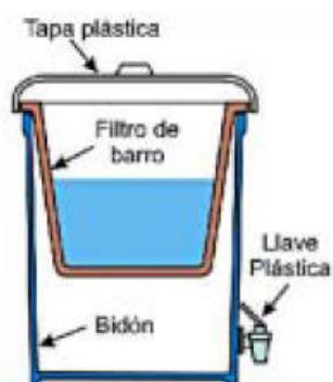
Figura 19: Elementos del filtro cerámico.
