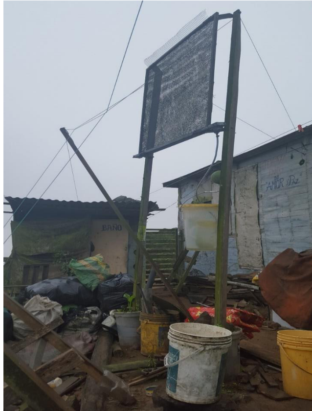
Figura 32: Neblinómetro SFC instalado dentro de la vivienda de una vecina.
