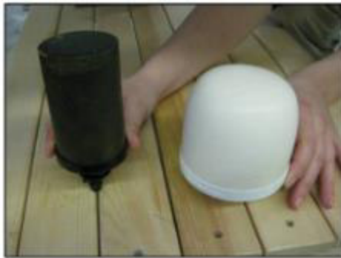
Figura 17: Diversas formas del filtro cerámico tipo vela
