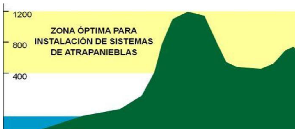
Figura 12: Esquema de zona óptima para instalación de captadores de neblinas.
