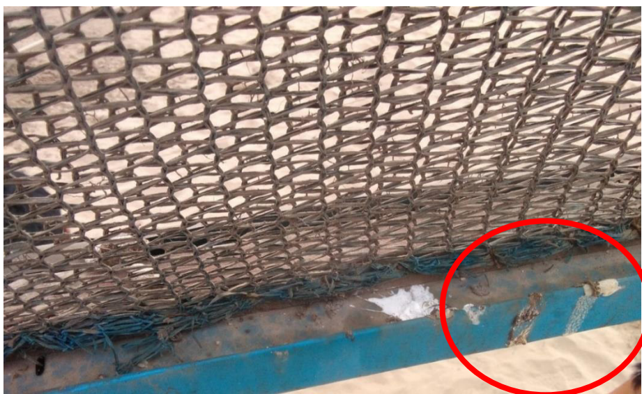
Figura 43: Heces de aves en la canaleta del neblinómetro SFC.
