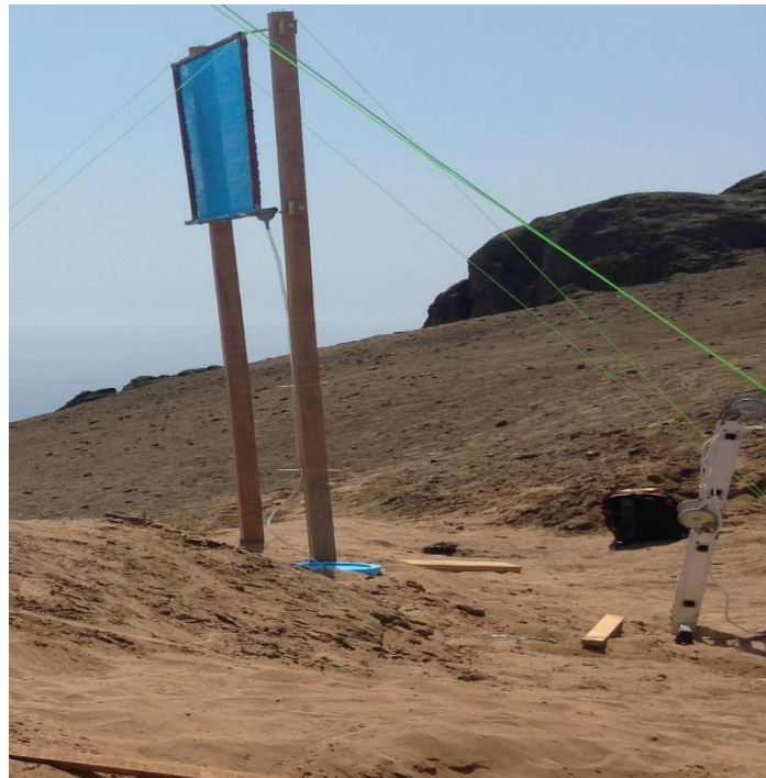
Figura 31: Tensando el neblinómetro SFC en la zona de estudio
