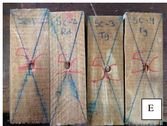
A) y C) Ensayo de dureza en extremos; B) y D) ensayo de dureza en lados E) probetas ensayadas
