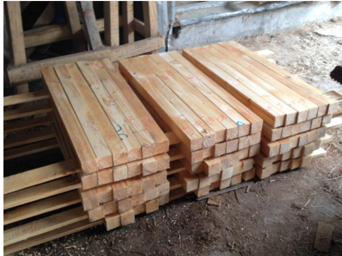
Figura 5: Listones de 5 x 5 cm apilados para la elaboración de las probetas
