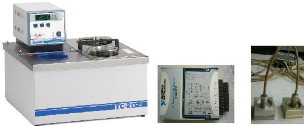
Figura 14. Equipos utilizados en el registro de la historia térmica
