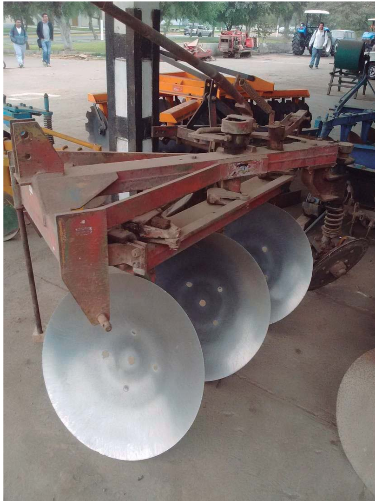
Fig. N° 25. Arado de discos reversible con 3 discos de 70 cm. de diámetro de manufactura nacional.
