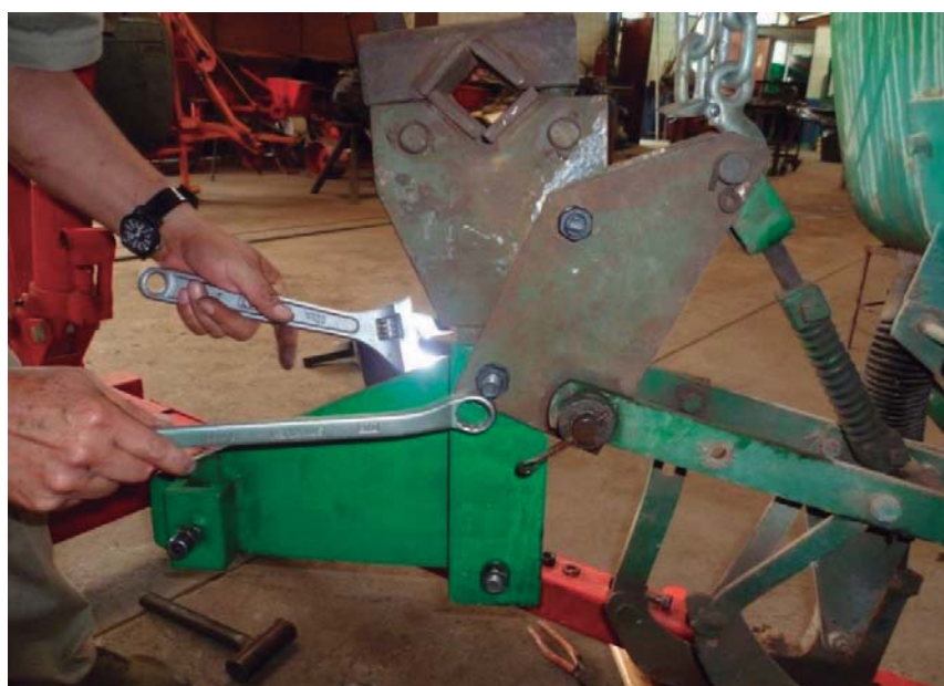
Fig. N° 30. Armado del accesorio para siembra directa en la sembradora de origen americano.
