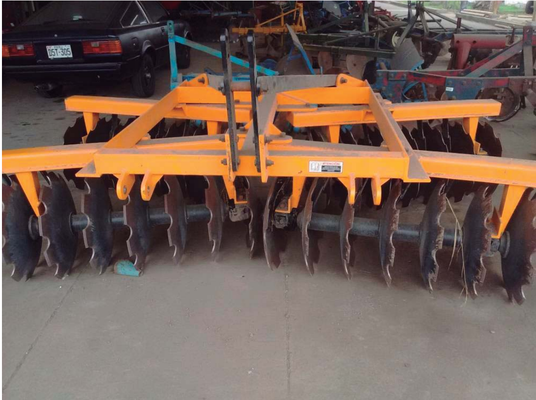
Fig. N° 26. Grada de discos integral con 28 discos de 4 cuerpos y discos de 55 cm. de diámetro de manufactura nacional.
