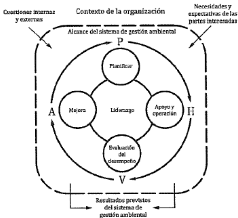
Figura N° 5: Relación entre el modelo PHVA y el marco de referencia en la ISO 14001:2015
