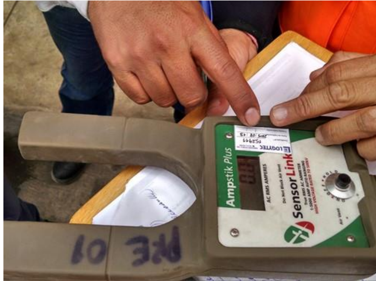
Pinza amperimétrica de media tensión
