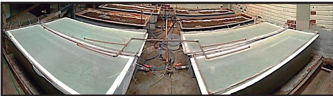
Figura 2: Tanques de bioreactores del sistema biofloc a diferentes relaciones C:N.
