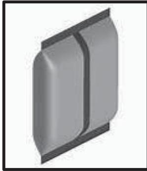
**Figura 3. Bolsa tipo “almohada” (con soldadura longitudinal y dos transversales en los extremos).**
