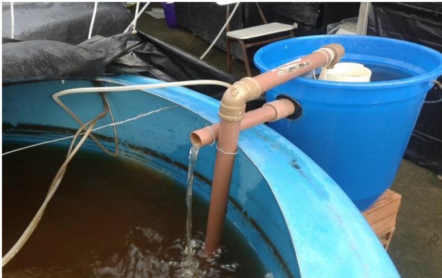
Figura 3.5. Sedimentador para el control de sólidos en los tratamientos con tecnología de bioflocs con y sin sustrato.
