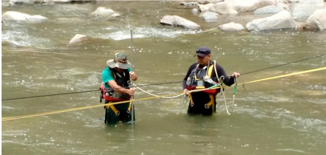
Figura 10: Aforo por vadeo en la estación hidroétrica Fuente: V&A Consulting Engineering SAC (2015)
