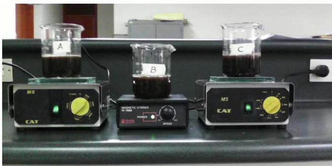
Figura 17: Agitación de las muestras por una hora a 400 rpm.
