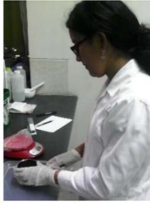
**Figura 31: Determinar el peso del Anillo II lleno de sustrato húmedo.**
