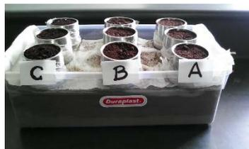
**Figura 29: Después de la saturación los cilindros se colocan en el cubo de arena. Previamente se coloca un papel filtro sobre la arena**
