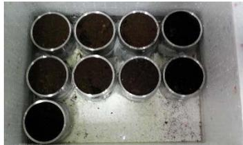
**Figura 26: Anillos llenos de sustrato y puestos en el recipiente de tecknopor.**
