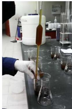
**Figura 21:** Se tomó una alícuota de 10 ml del sobrenadante.
