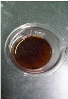
**Figura 20:** Muestra 1 g. diluido en 100 ml de agua destilada, se dejó reposar 15 minutos para separar el sobrenadante.
