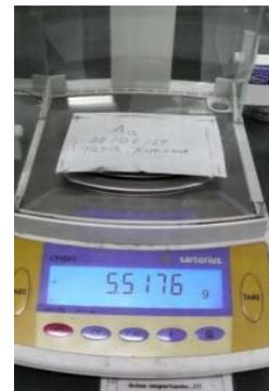
**Figura 15: Luego de 24 horas, se calculó el peso seco de las muestras.**
