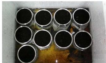
**Figura 28: Saturación de las muestras por 48 horas.**
