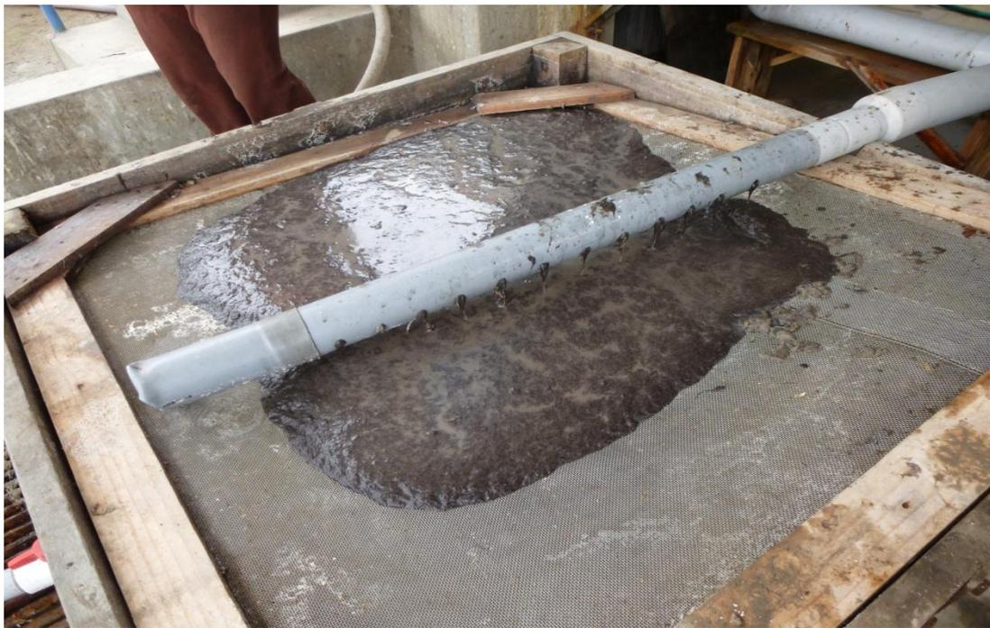
**Figura 4: Residuos de pelos filtrados a la salida del efluente del proceso de pelambre.**
