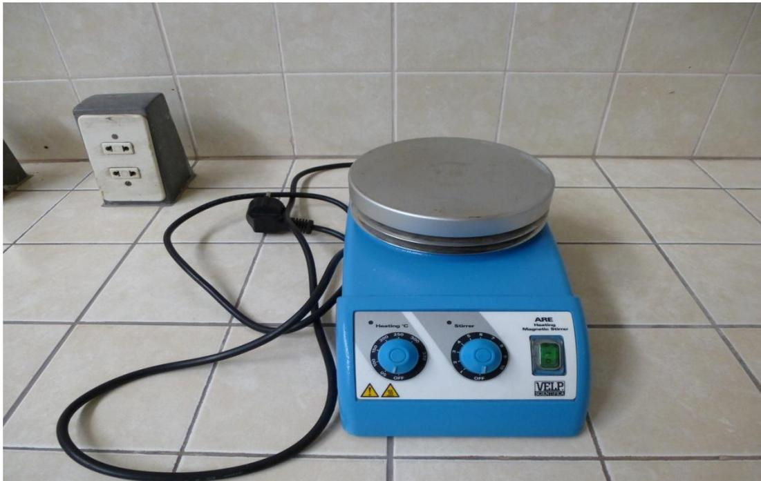
**Figura 7: Agitador magnético. Marca VELP SCIENTIFICA.**
