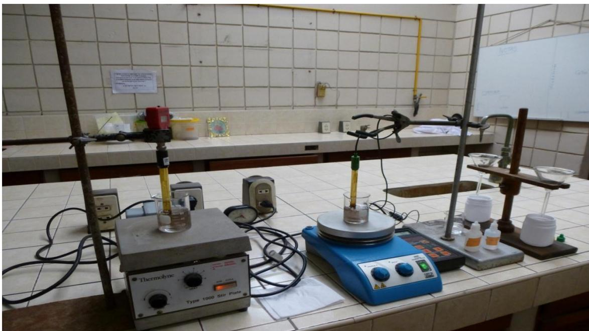
**Figura 11: Esquema general de los test de adsorción tipo Batch.**
