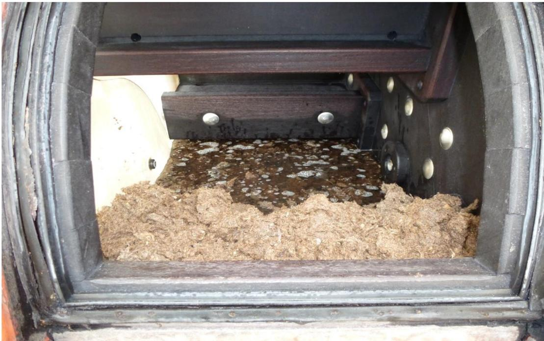
**Figura 6: Lavado de los residuos de pelos del proceso de pelambre.**
