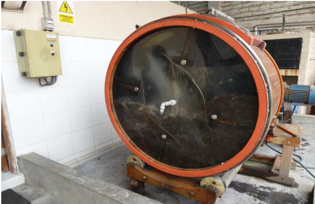
**Figura 5: Botal pequeño usado para el lavado de los residuos de pelos.**
