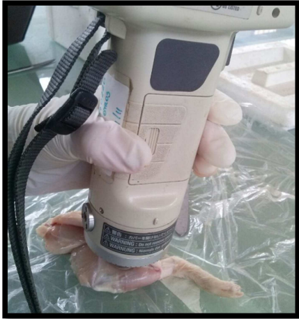
Figura 11. Medición del color en el músculo Biceps femoris .
