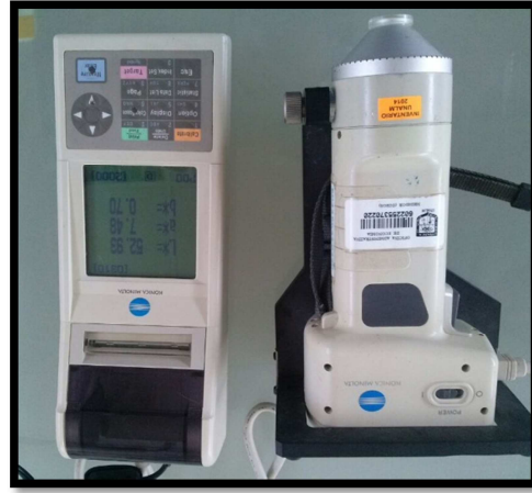
Figura 12. Colorímetro MINOLTA modelo CR400.
