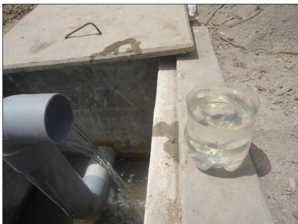
**Figura 26: Medición del caudal de salida del humedal**
