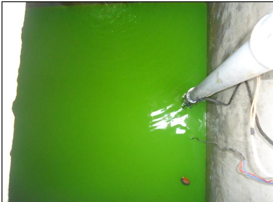
Anexo 7.4 Vertimiento del trazador en cisterna con agua residual pretratada
