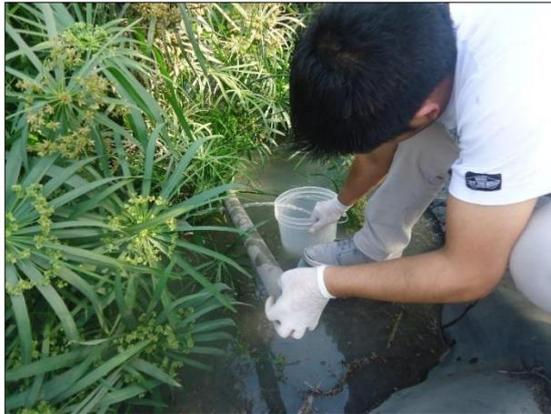
**Figura 25: Medición del caudal de ingreso al humedal**
