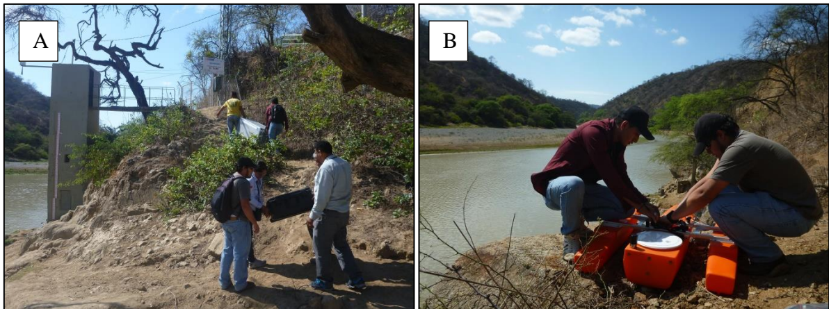
Figura 46: Inicio de la primera campaña de aforos con ADCP, en estación El Tigre
