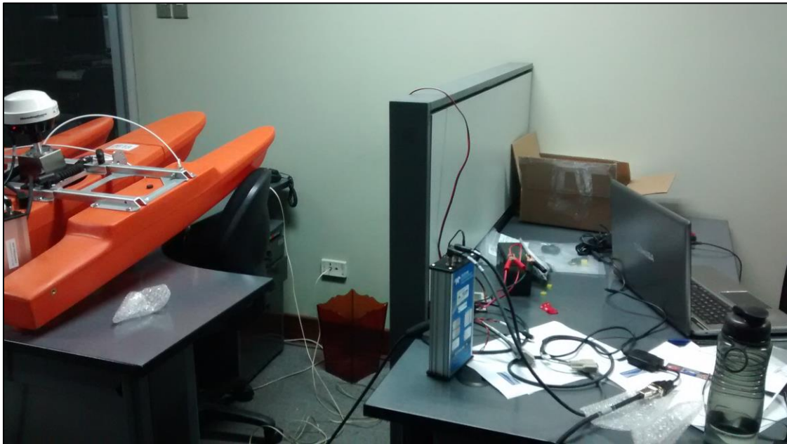
Figura 45: Prueba de conectividad del ADCP con laptop mediante radio modems
