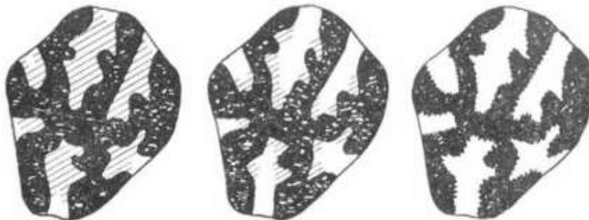
**Figura 10: Proceso de activación del carbón activado.**
