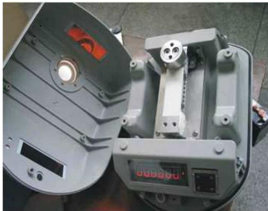
Doble encapsulado para los displays frontal y posterior con junta a prueba de agua.
