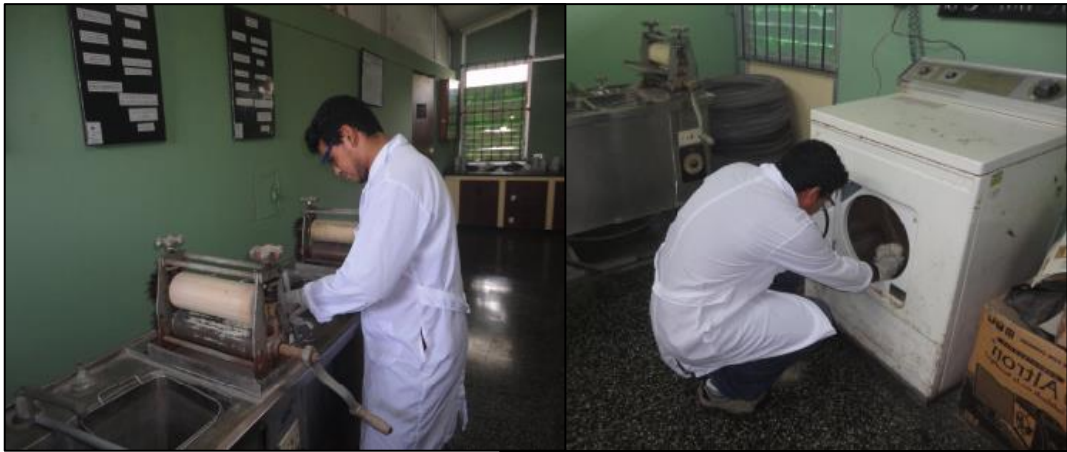
Proceso de lavado de las muestras de fibras.
