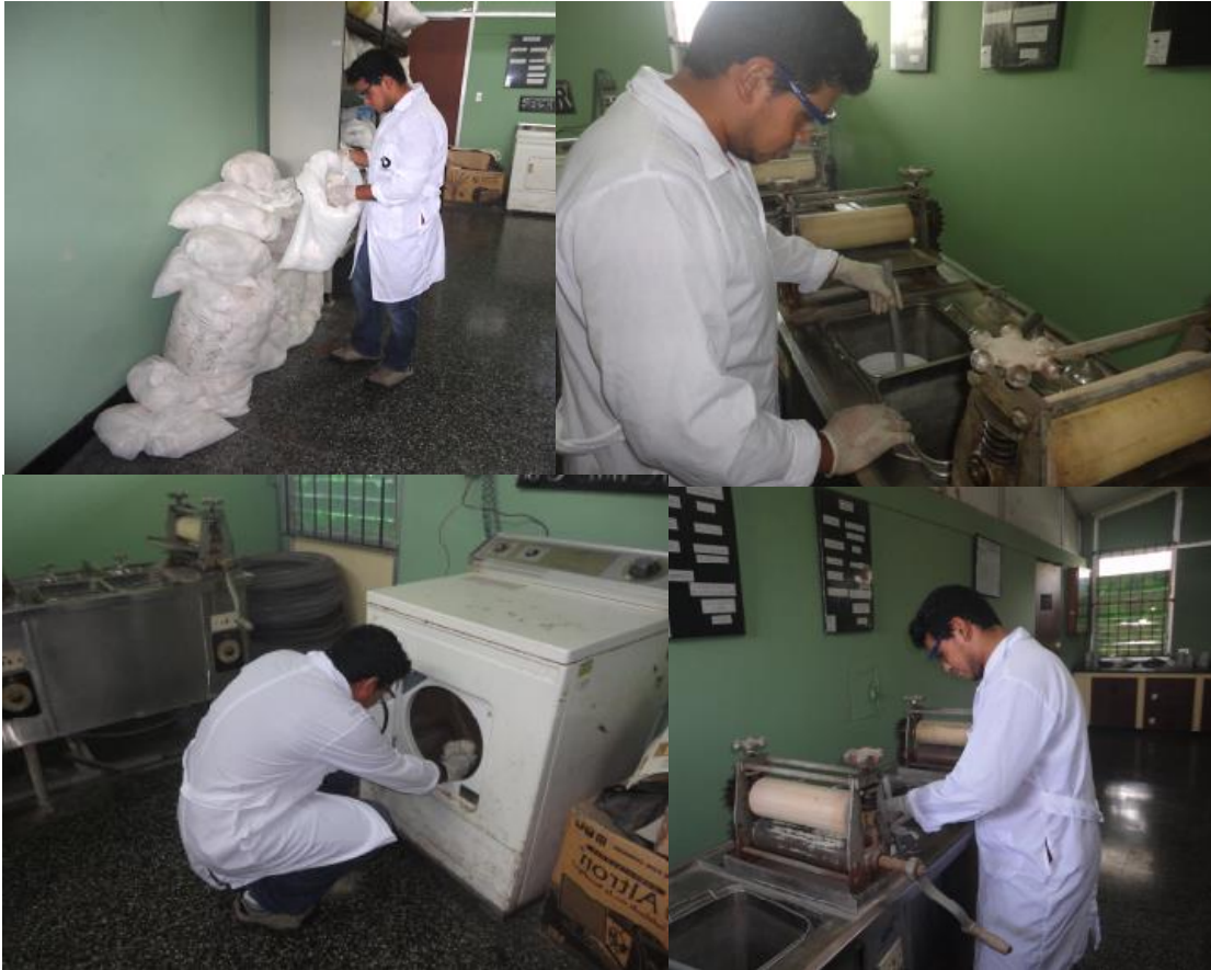
Figura 9: Proceso de lavado y secado de las muestras de fibra.
