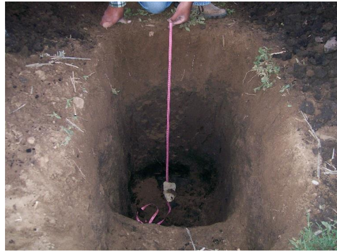
Figura 3: Reconocimiento del perfil del suelo en la parcela estudiada: Arriba Izq: Excavado de calicata, Der: Descripción del perfil. Abajo Izq: porción de suelo orgánico extraída del horizonte enterrado, Der : Perfil del suelo
