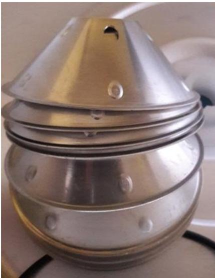
**Figura 23: Platos cribados de la descremadora**
