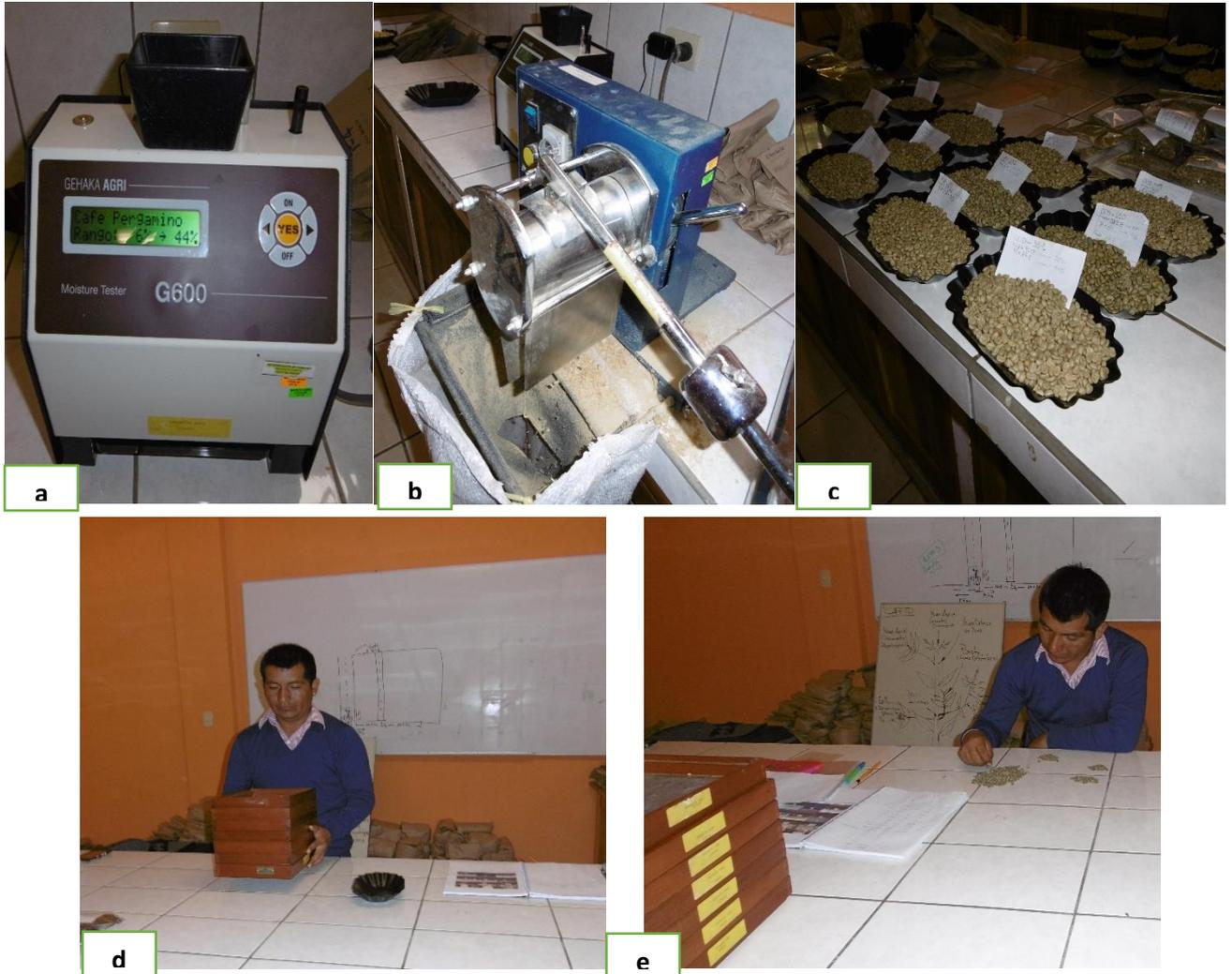
(a) Medidor de Humedad, (b) Trillando, (c) Café de grano de oro, (d) Zarandas para la prueba de granulometría con café grano de oro, (e) Seleccionando granos por defecto.
