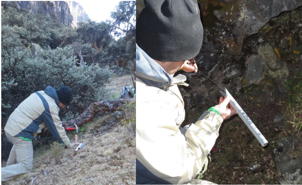
a) Introducción de la estaca en el suelo mediante el uso del martillo. b) Introducción del bloque de yeso en el tubo de PVC.
