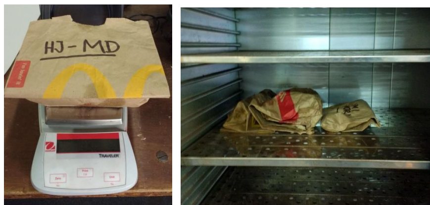
a) Tarado, pesaje. b) introducción de las muestras a la estufa eléctrica
