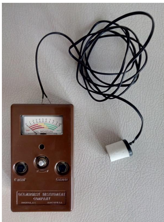
Figura 3: Sistema de medición de humedad
