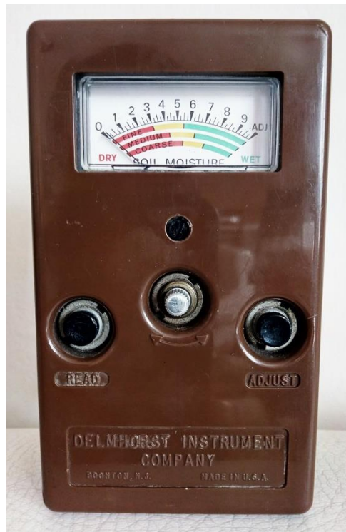
Figura 4: Medidor de humedad KS-1
