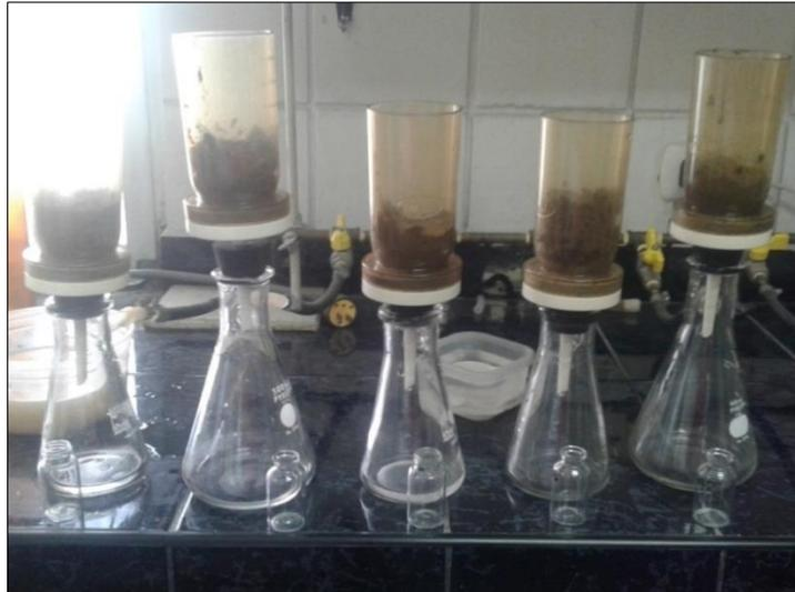
**Figura 5:** Obtención del extracto de saturación
