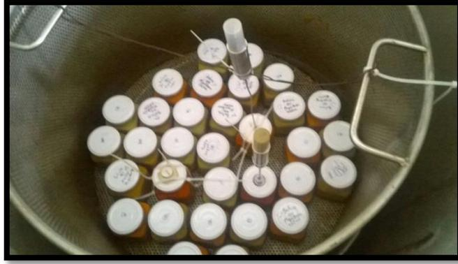
**Figura 9: Disposiciones de los envases de vidrio para la determinación del punto más frío.**
