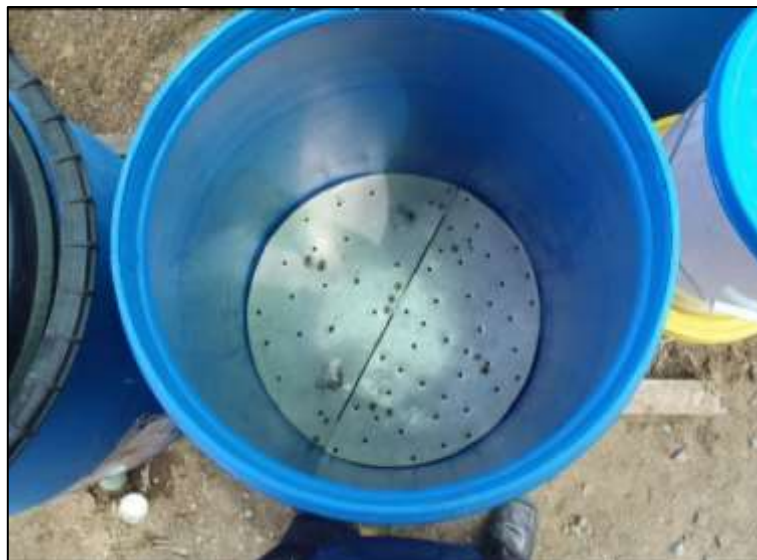
Figura 22: Interior de biodigestor con coladera interior
