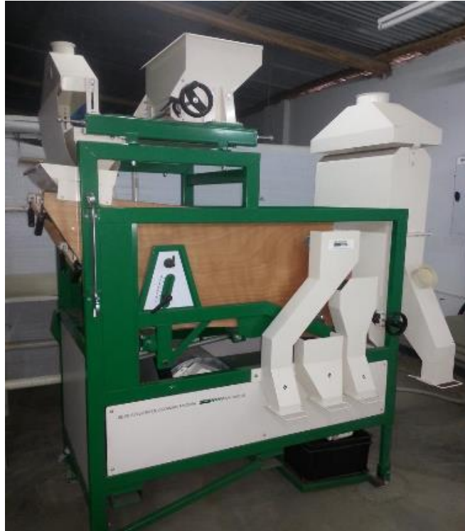
Figura 23: Limpiador de semilla de aire y zarandas
