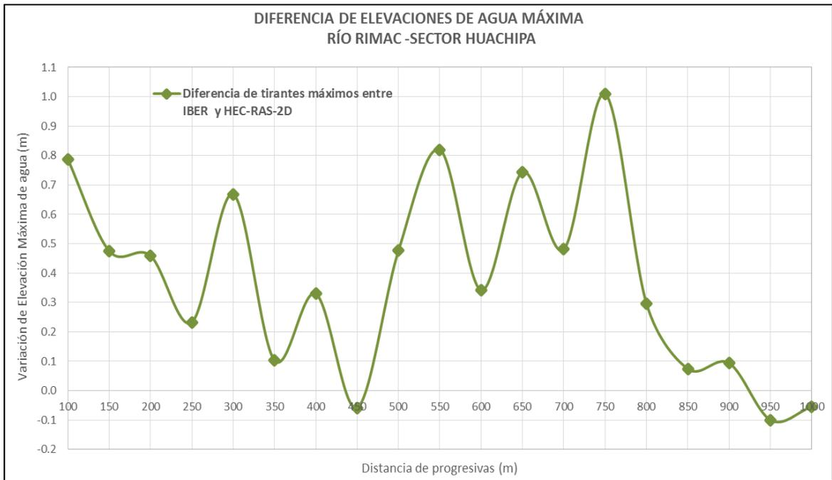
**Figura 66. Diferencia de elevaciones de agua máximas entre HEC-RAS 2D e IBER.**
