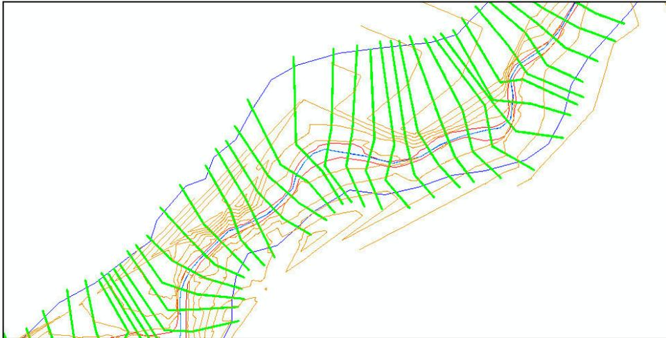
**Figura 4 Trazado de las secciones transversales**
