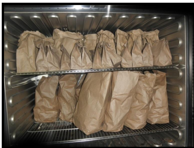
Figura 8: Crisantemos llevados a estufa para obtener el peso seco.
