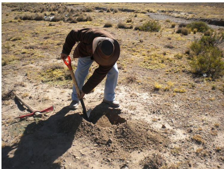
Figura 9: Calicata para la extracción de la muestra de suelo
