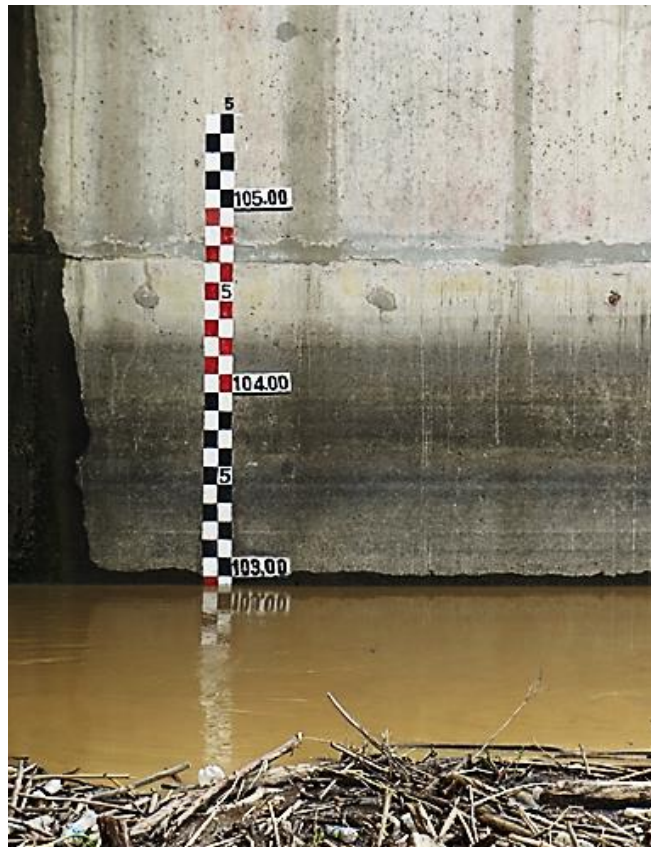
Foto 4: Regla de niveles de operación del embalse Poechos, se muestra cotas 103.00 a 105.50 del sistema OLSA
