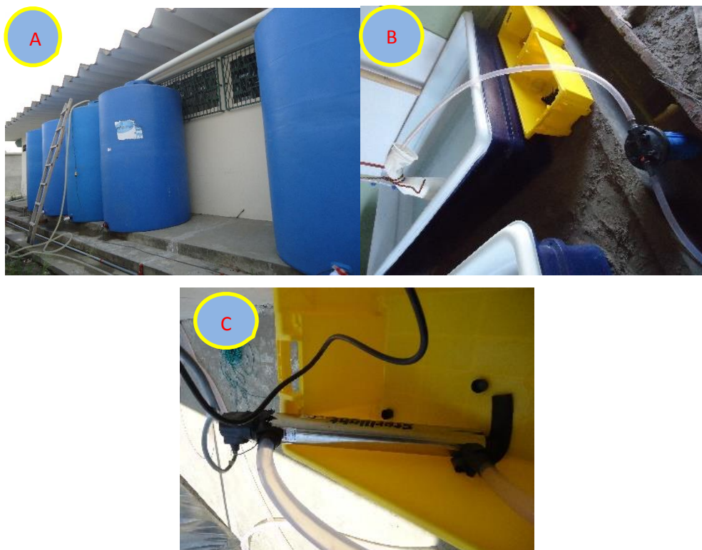
Figura 4. Tratamiento de agua de mar para experimentación A: tanques para recepción de agua de mar, B: filtración de agua con filtro de hilo de algodón de 5 micras, y filtro de cartucho de 5 micras, C: irradiación de agua con lámpara UV.
