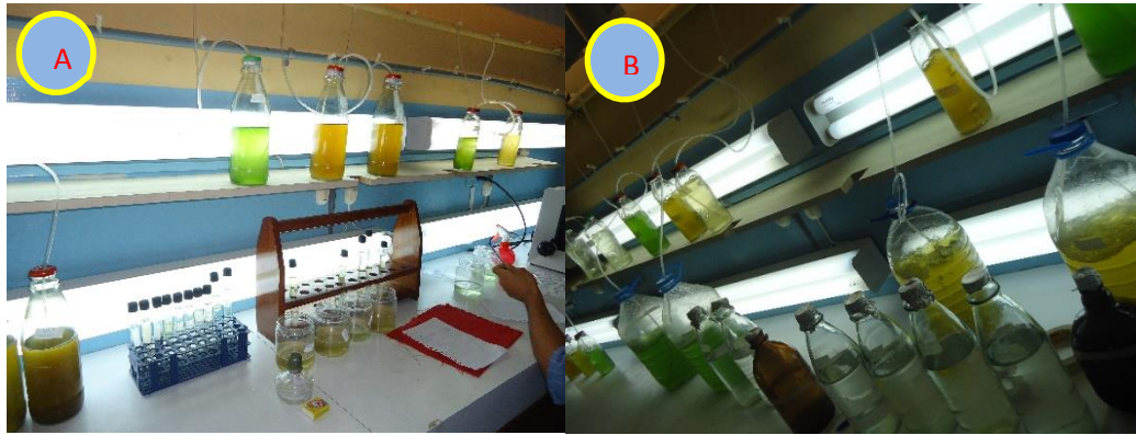
Figura 5. Fase intermedia de cultivo de microalgas A: fase de cultivo en tubo de ensayo y matraces de 0,5 litro, B: fase de cultivo en garrafrones de 4 litros
