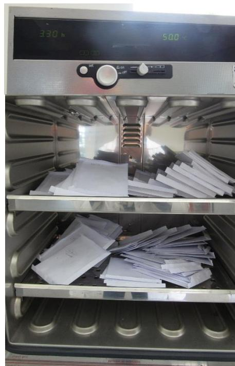
**Figura 8: Estufa para esterilizar y para obtener peso seco de material vegetal.**
