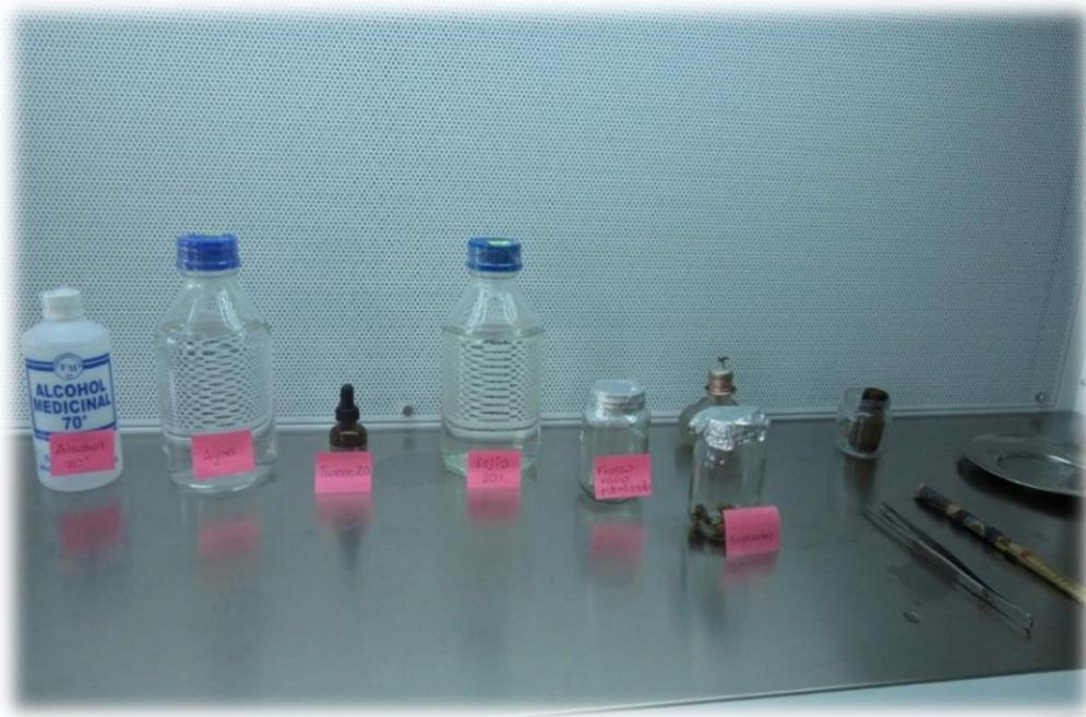
**Figura 11: Materiales para la desinfección dentro de cámara de flujo laminar.**
